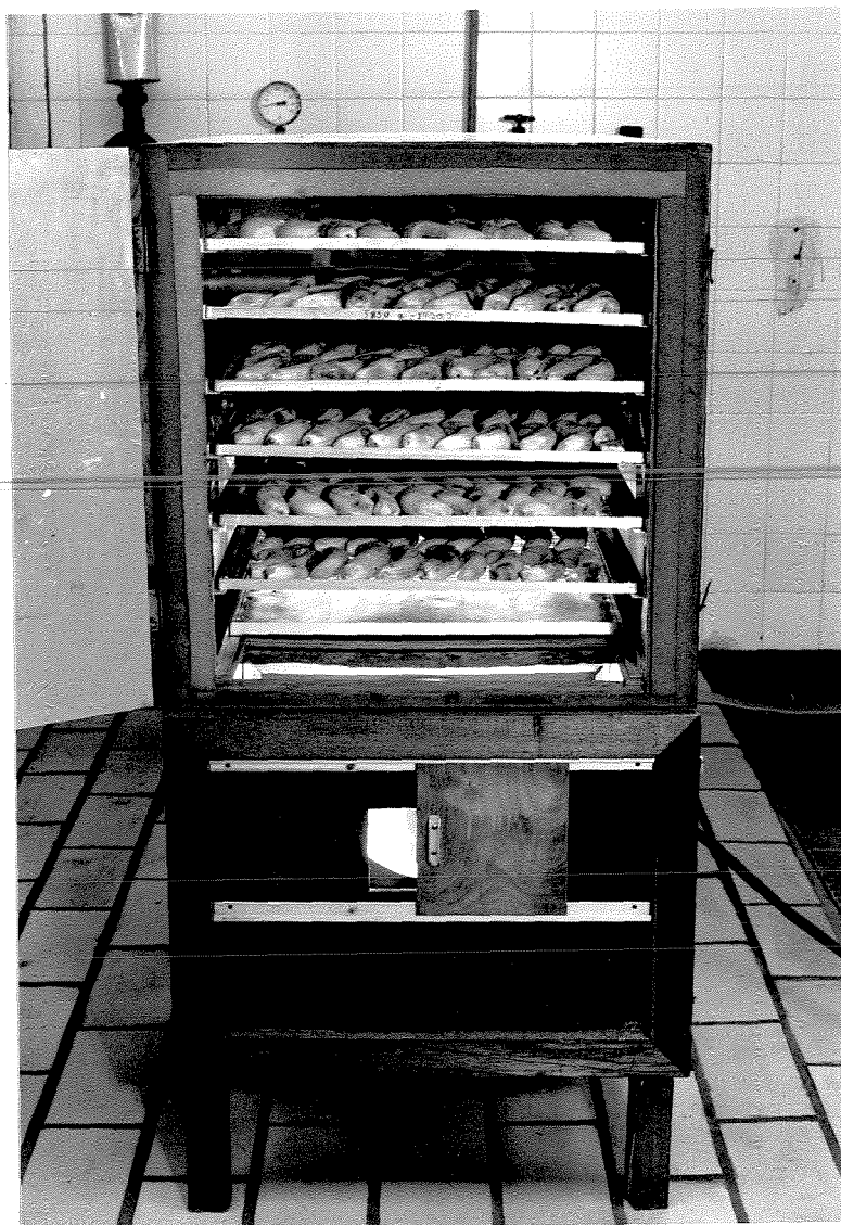
Figura 5.3 - Secador carregado para o início do teste
