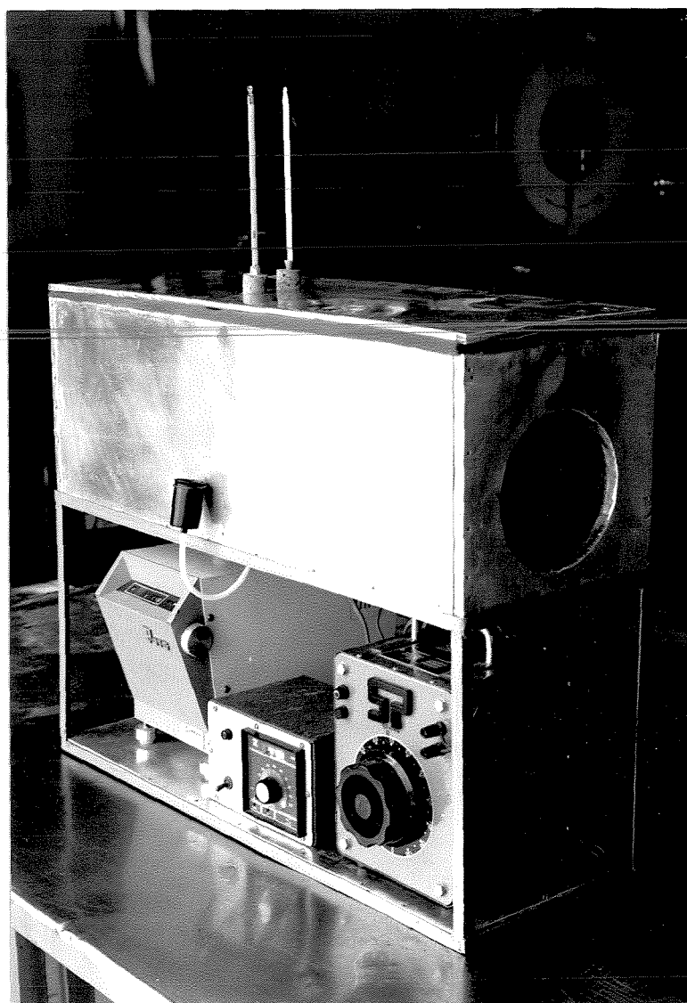
FIGURA 4.1. - Aparelho laboratorial para controle de perda de umidade.
