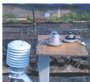
Figura 14 Radiômetro Quantum , piranômetro de Eppley para radiação global e sensores de temperatura e umidade relativa do ar.
