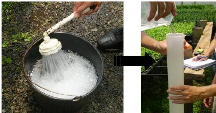
**Figura 3.** Detalhe da determinação da vazão pelo método volumétrico em visita técnica a propriedade produtora de mudas cítricas.
