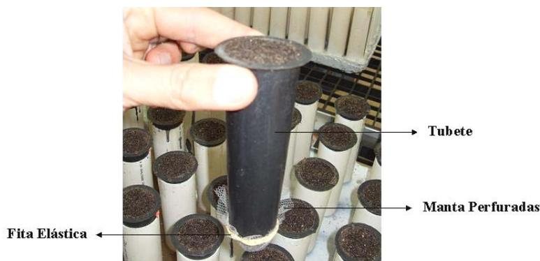
**Figura 17.** Tubete preenchido com substrato de casca de pinus utilizado na caracterização hidráulica de bandejas de irrigação por capilaridade.
