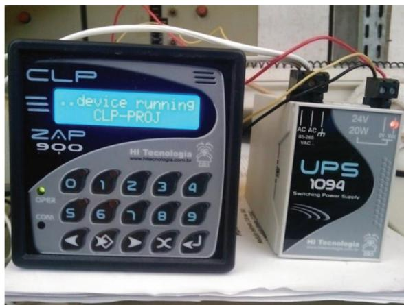
**Figura 23 – CLP ZAP 900 e Fonte de Alimentação UPS 1094**
