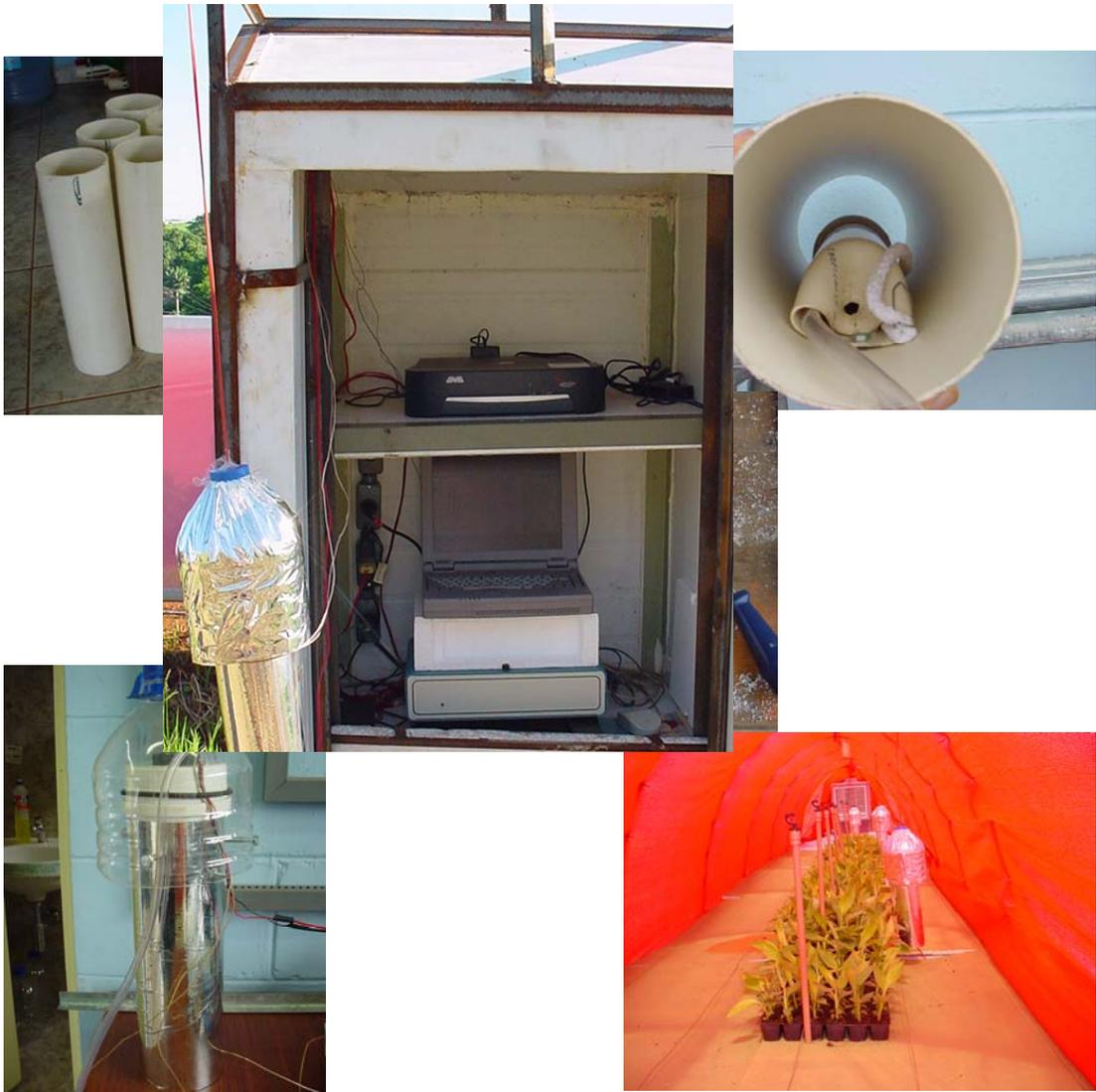
Figura 10 – Detalhes na construção dos psicrômetros aspirados e sua disposição nos ambientes.
