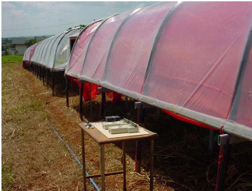
Figura 25 – Data-Loggers LI-COR 1400 conectados a sensores externos e internos.
