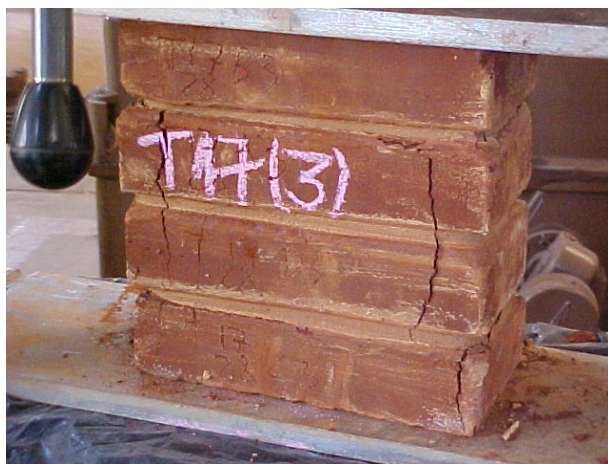
Figura 81. Exemplo de fissuras verticais e horizontais nos mini-painéis após a ruptura.
