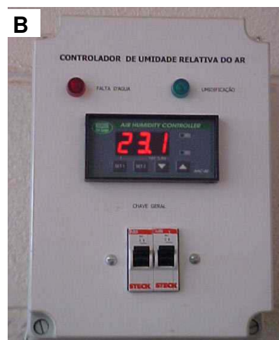
Figura 10. Detalhes do umidostato/termostato digital mostrando a umidade relativa (a) e a temperatura (b) da câmara-úmida.
