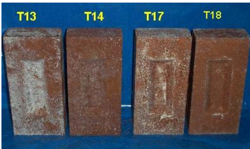
Figura 74. Eflorescência de \text{CaCO}_3 nos tijolos argilosos tratados com \text{Na}_2\text{SiO}_3 .
