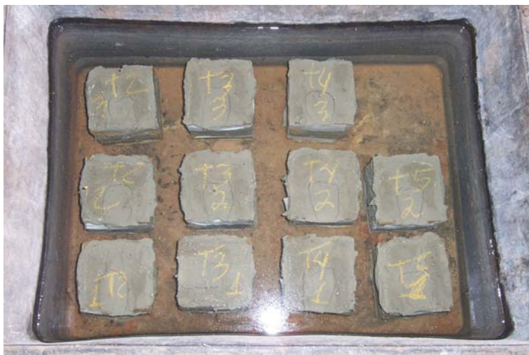
Figura 19. Prismas sob imersão em água.
