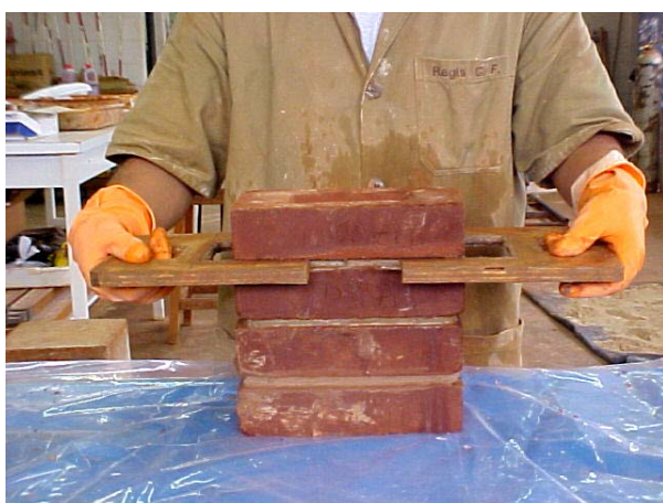
Figura 25. Retirada da guia.
