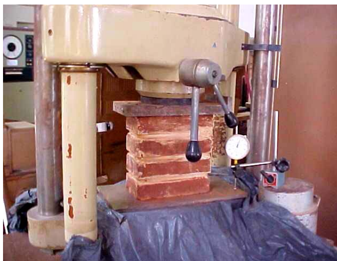
Figura 31. Mini-painel sob compressão simples.
