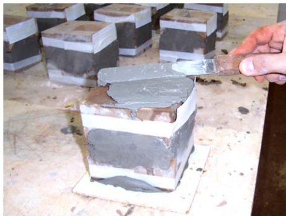
Figura 17. União das duas metades e capeamento do prisma.
