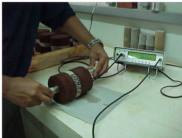
Figura 32. Teste preliminar para a escolha da frequência de ressonância.
