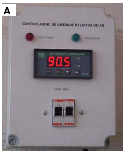
Figura 10. Detalhes do umidostato/termostato digital mostrando a umidade relativa (a) e a temperatura (b) da câmara-úmida.
