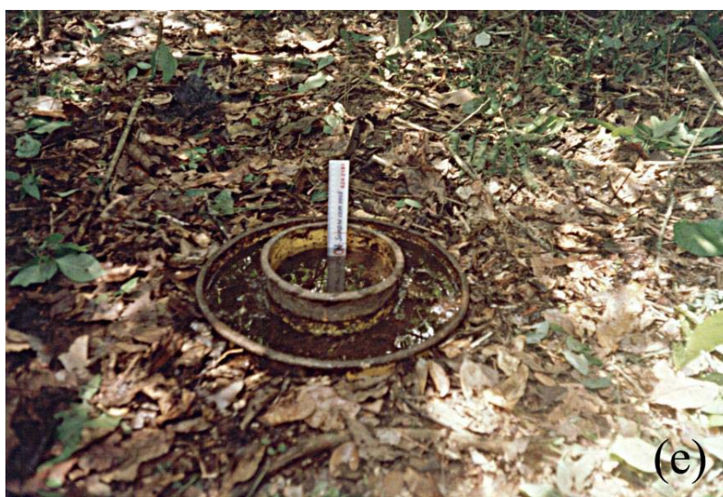
FIGURA 8 - Material utilizado para amostragem e caracterização dos solos. (a) trado de caneca; (b) amostrador de koppec; (c) trado holandês; (d) penetrógrafo eletrônico automático; e (e) anel de infiltração para determinação da curva de infiltração da água no solo.
