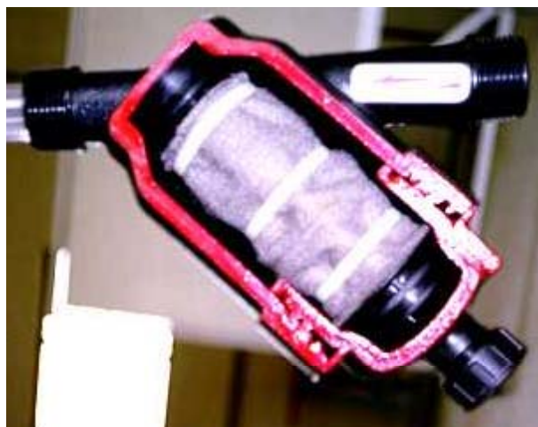
Figura 6 - Filtro de irrigação contendo elemento filtrante de manta sintética não tecida.
