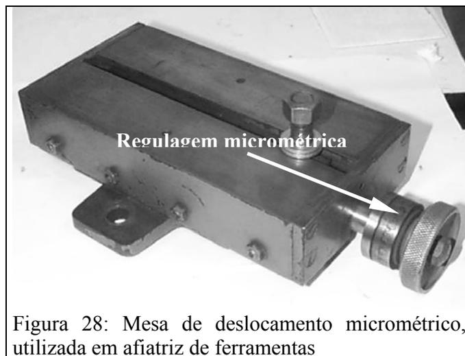
Figura 28: Mesa de deslocamento micrométrico, utilizada em afiatrix de ferramentas
