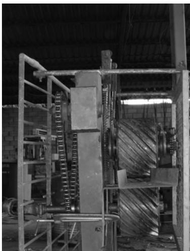
**Figura 16.** Vista lateral do despalhador
