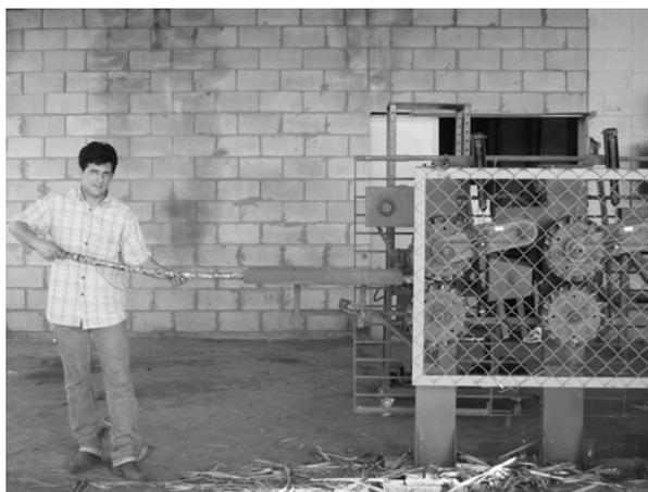
**Figura 24.** Introdução manual e individual dos colmos pelo despalhador.
