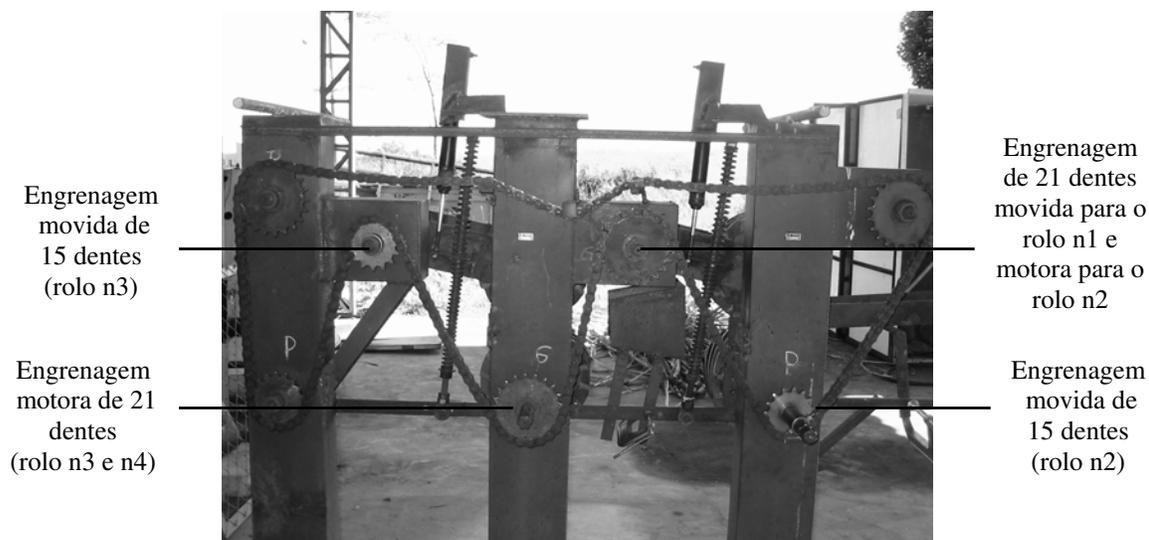
**Figura 18.** Vista posterior do despalhador.
