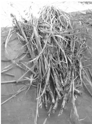
**Figura 22.** Grupo de colmos antes de ser submetido ao ensaio.
