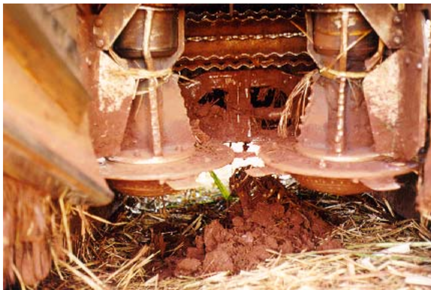
Figura 64. Limpeza do rolo levantador da máquina e calotas limpas.
