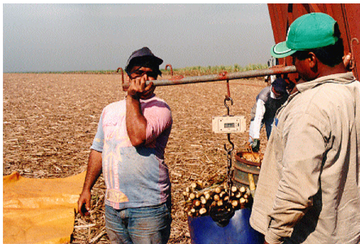
Figura 44. Pesagem de rebolos, por meio de uma célula de carga.
