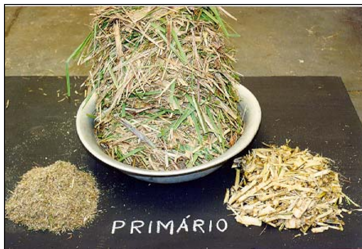
Figura 61. Perdas Invisíveis, serragem e lacas recolhidas no extrator primário.
