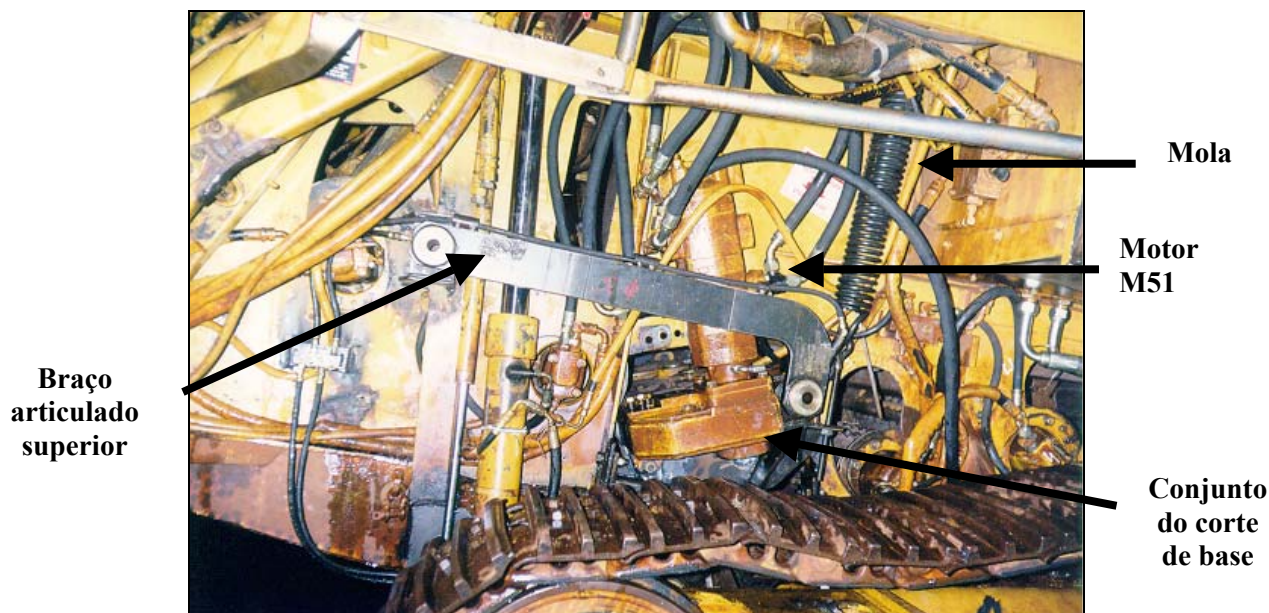
Figura 21. Vista Lateral do Corte Basal Flutuante na Cameco CH 2500
