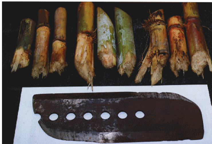
Figura 59. Facas usadas e rebolos de cana: RB72454, SP80-1842 e RB806043, da esquerda para a direita.
