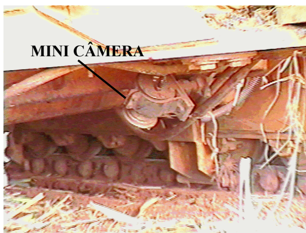
Figura 18. Suporte protetor da mini câmera instalado no chassi da colhedora.
