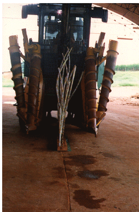
Figura 14. Teste de corte de base com simulador.
