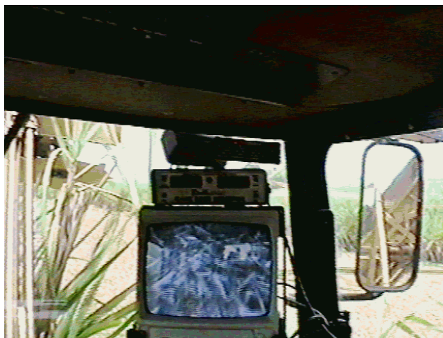
Figura 17. Monitor de vídeo 9” montado na cabine da colhedora, em conjunto com o monitor de perdas.
