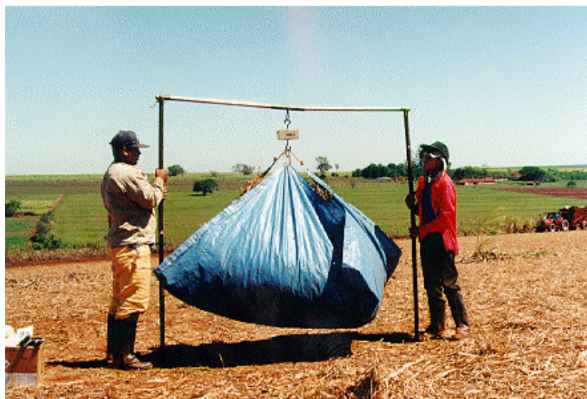
Figura 36. Pesagem da palha remanescente no campo utilizando célula de carga.
