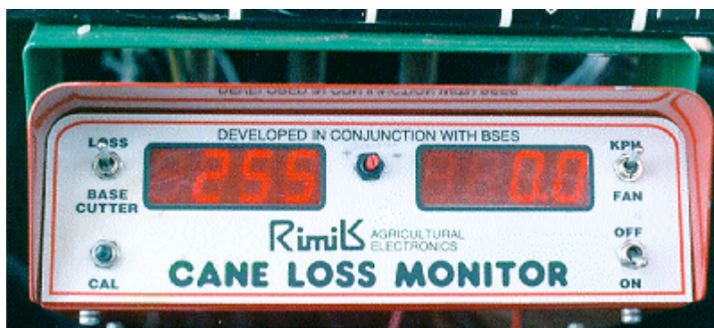
Figura 25. Monitor de perdas de cana instalado próximo ao comando da colhedora.
