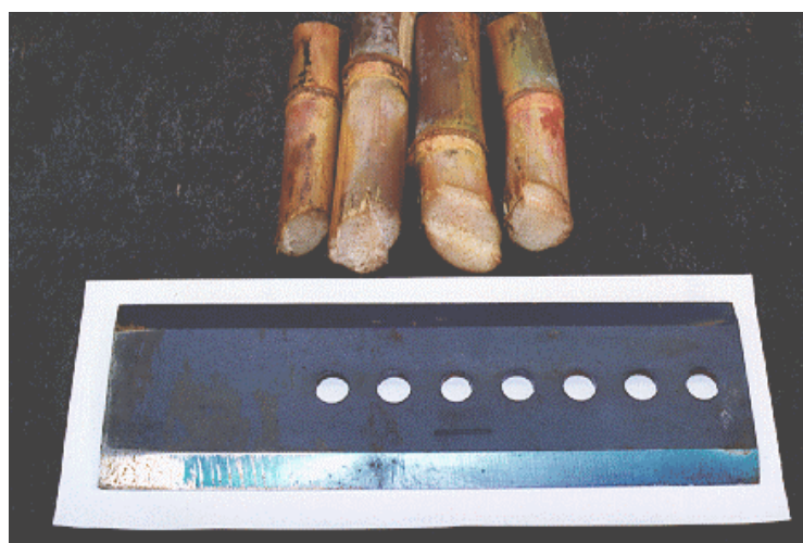
Figura 58. Faca nova e cana cortada.
