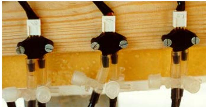
**Figura 7 - Foto ilustrando transdutores de pressão**
