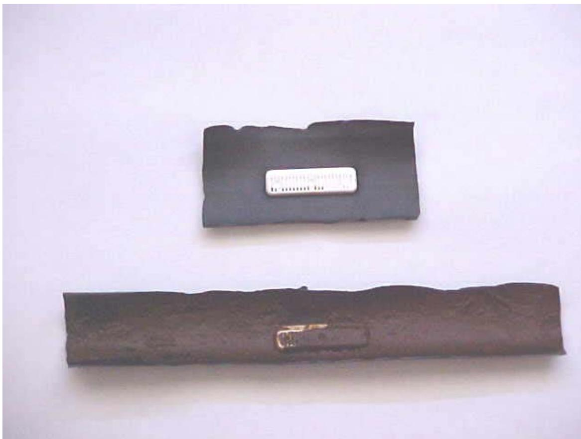
**Figura 62– Foto de gotejador novo (parte superior) em contraste com outro utilizado na pesquisa.**
