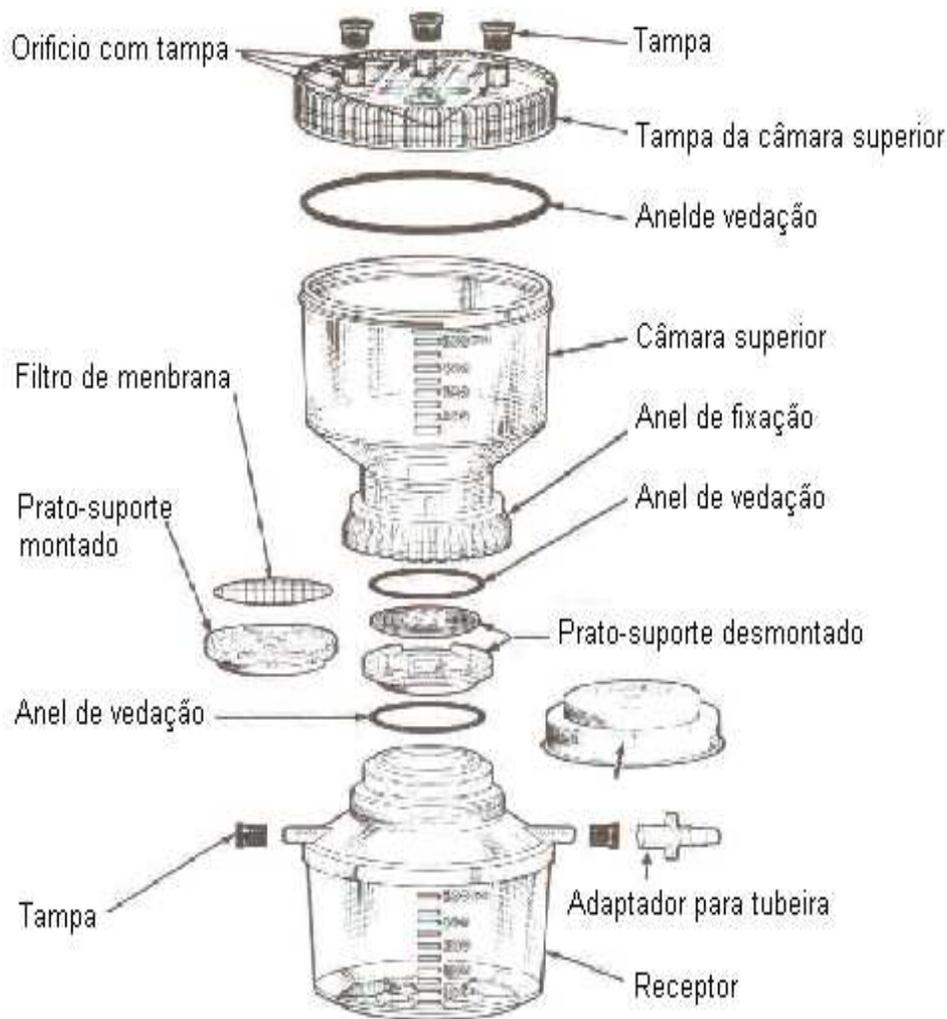
**Figura 18** Suporte de filtro com receptor da marca NALGE COMPANY usado para determinação de sólidos suspensos totais
