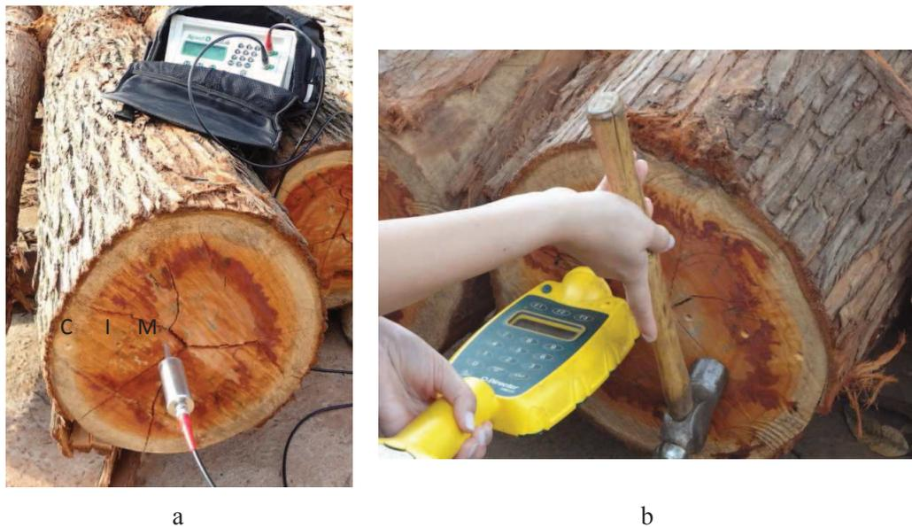
Figura 3.6. Ensaios longitudinais nas toras, nos pontos próximo à casca (C), próximo à medula (M) e um ponto intermediário (I) à esses dois pontos, utilizando o ultrassom (a) e o equipamento de vibração (b).
