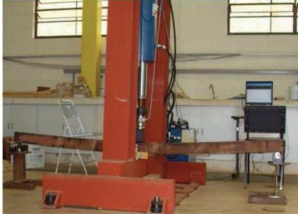
Figura 3.15. Esquema do ensaio de flexão na viga bi apoiada e com aplicação da carga centrada.
