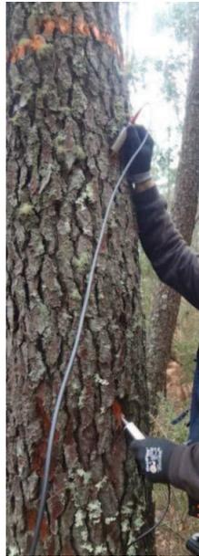
Figura 3.2. Ensaio de ultrassom na árvore.
