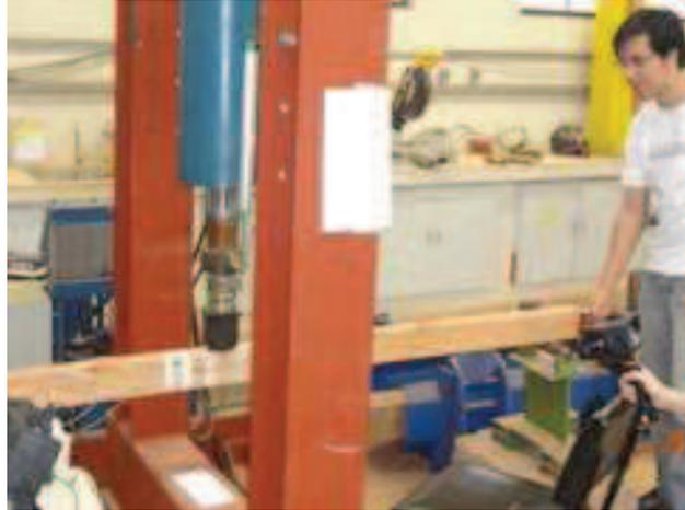
Figura 3.18. Ensaio de ultrassom realizado na direção paralela à fibra durante o carregamento da viga.
