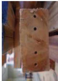
Figura 3.19. Furação na seção transversal da viga para inserção dos transdutores de faces exponenciais durante o ensaio de ultrassom na direção paralela às fibras.
