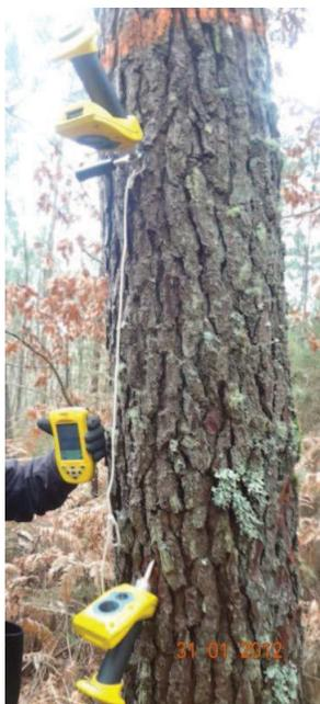
Figura 3.4. Ensaio nas árvores utilizando equipamento de ondas de tensão (ST300).
