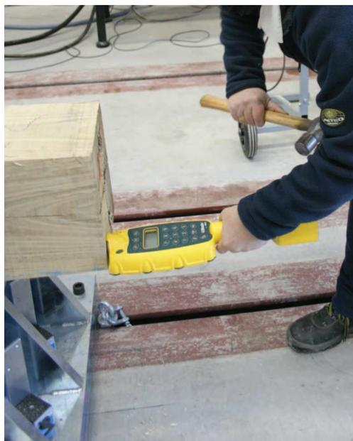
Figura 3.13. Ensaio de vibração longitudinal nas vigas de *Pinus pinaster*.
