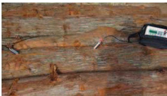
Figura 3.8. Ensaio de propagação de onda superficial na tora utilizando o ultrassom.
