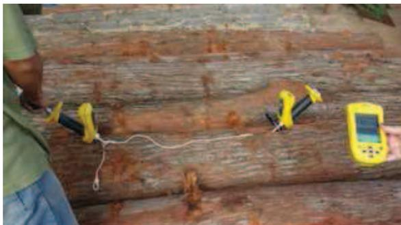
Figura 3.7. Ensaio de propagação de onda superficial na tora utilizando o equipamento de ondas de tensão.
