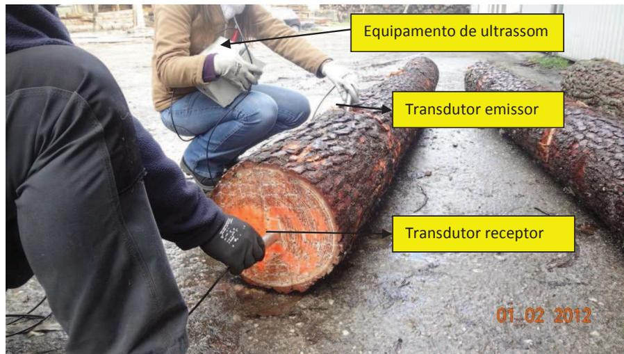
Figura 3.10. Representação do ensaio de dispersão da onda utilizando equipamento de ultrassom.
