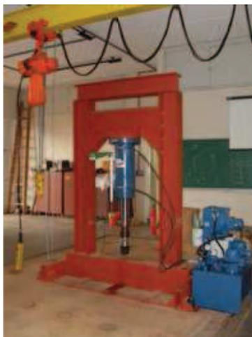
Figura 3.14. Pórtico com atuador hidráulico para ensaio de estruturas.
