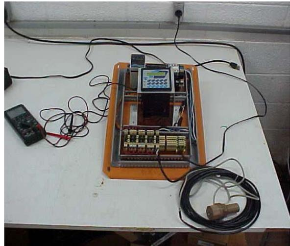
Figura 20. Painel com os equipamentos para automação (CLP, relês, etc)
