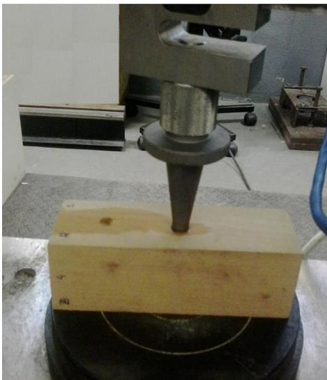
Figura 2. Ensaio de Dureza Janka.
