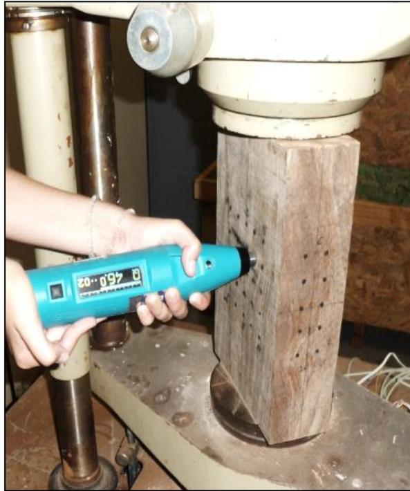
Figura 15. Método de aplicação da esclerometria na direção radial.
