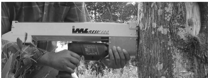
Figura 7. Aplicação do método do resistógrafo.
