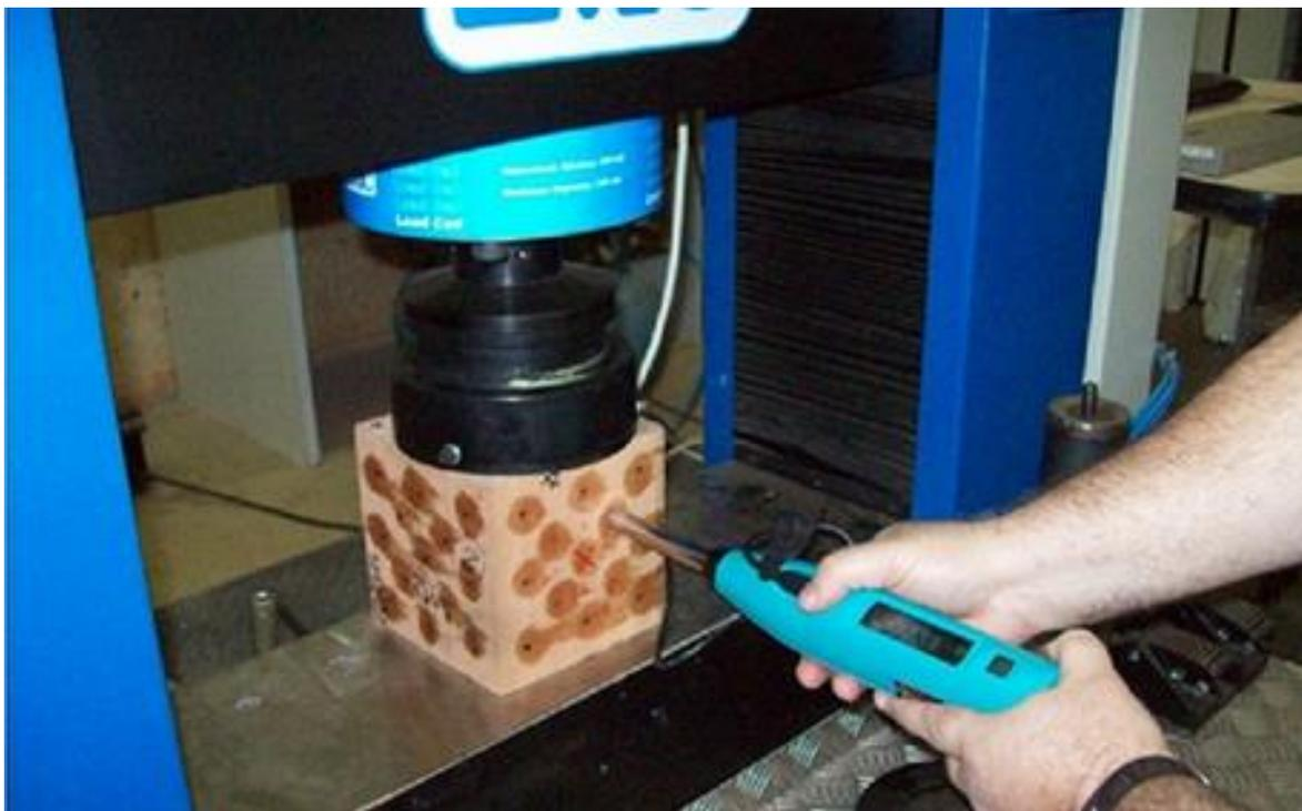
Figura 8. Aplicação de golpe esclerométrico na madeira.
