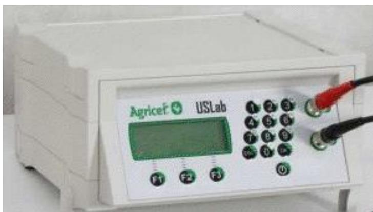
Figura 17. Aparelho de ultrassom (USLab, AGRICEF).
