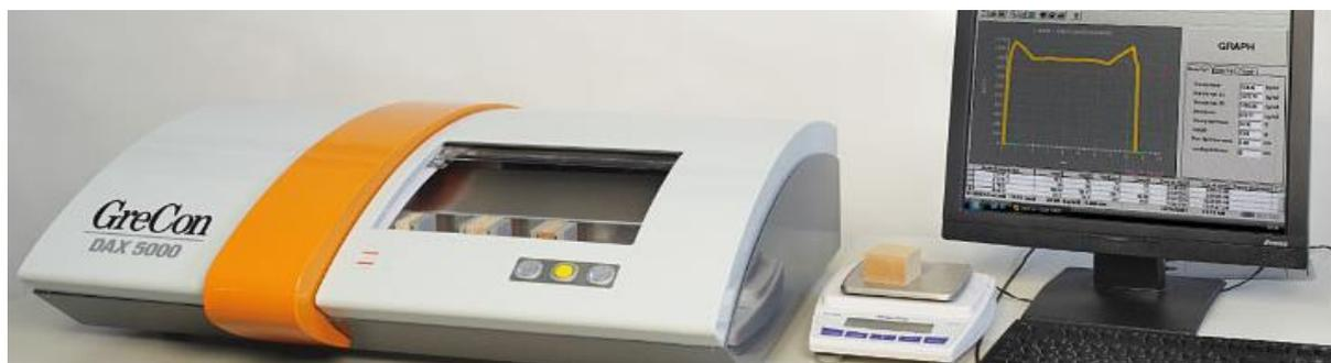
Figura 5. Equipamento para obtenção de densidade por Raios-X.
