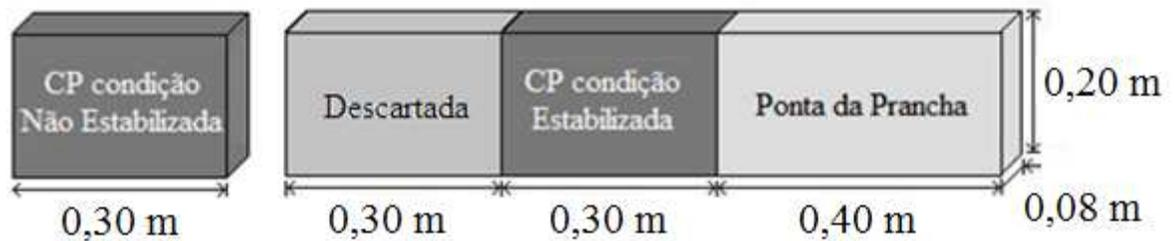
Figura 12. Esquema para extração dos corpos de prova das espécies submetidas à secagem em estufa.
