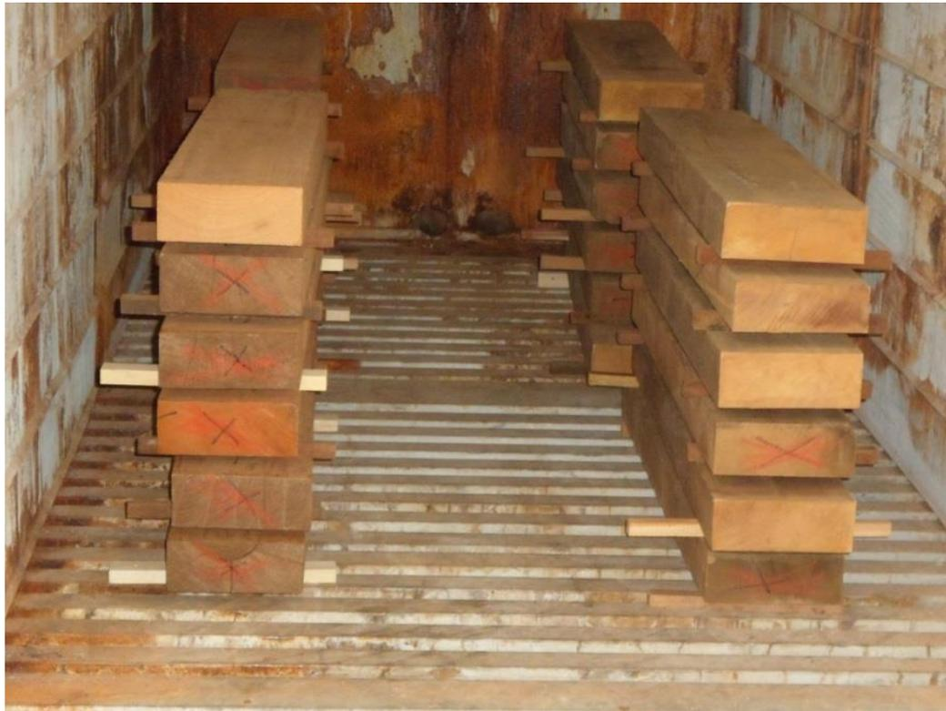
Figura 11. Estabilização das peças em câmara de climatização e secagem.
