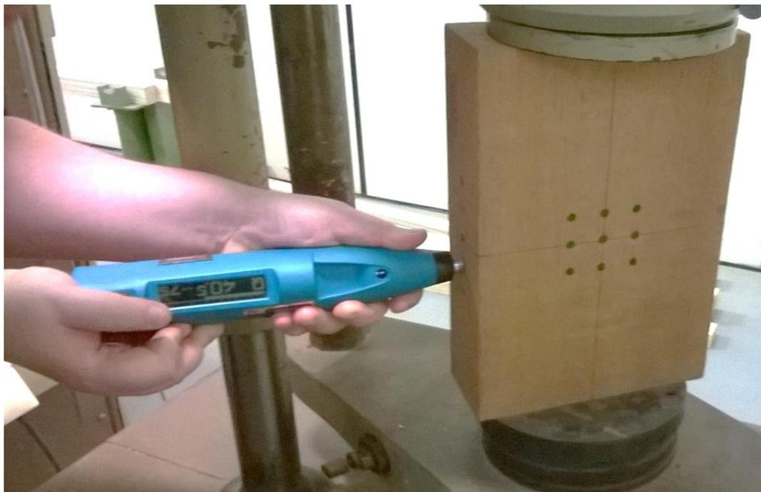
Figura 16. Método de aplicação da esclerometria na direção tangencial.
