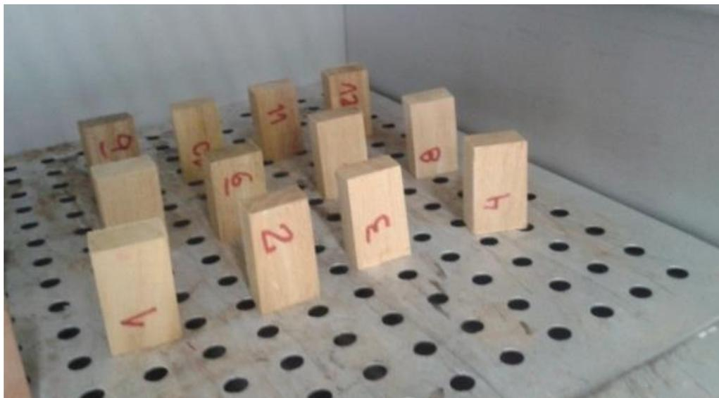
Figura 18. Corpos de prova para determinação do teor de umidade e densidade aparente.
