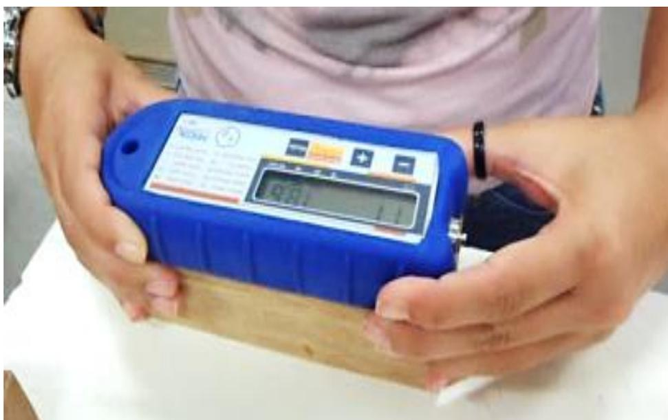
Figura 4. Medição de umidade (MP1-E, Merlin).
