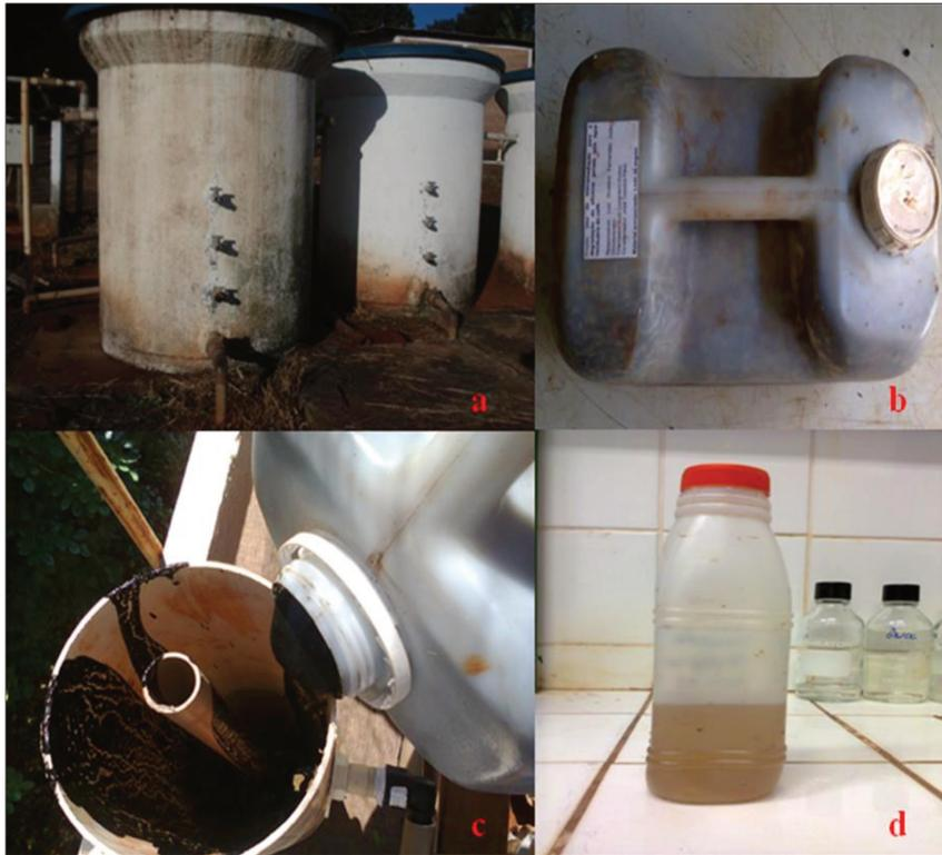
**Figura 18.** a. Reatores RAC onde foi retirado o lodo de esgoto; b. lodo armazenado em câmara fria a 4°C; lodo de esgoto inserido no reator e d. composto biológico.
