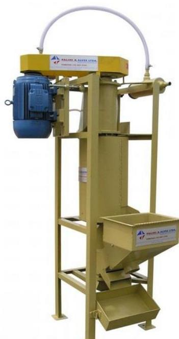
**Figura 7.** Desmuscilador vertical de café. Fonte: Palini e Alves, 2013.
