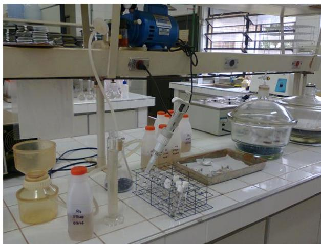
**Figura 14.** Processo de filtragem das amostras para SST e SSV.
