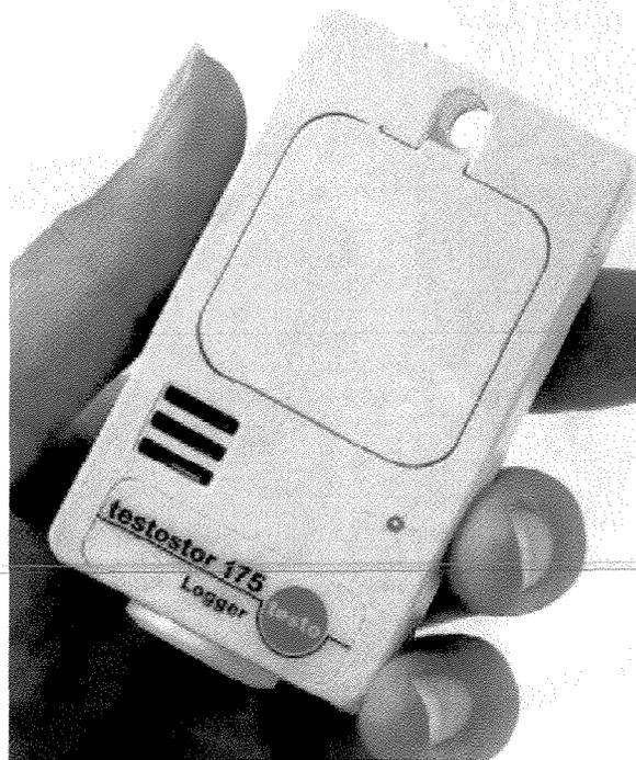
**Figura 7.** Registrador de temperatura e umidade relativa do ar (*Datalogger*).
