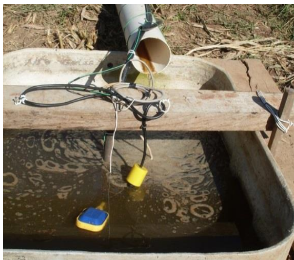
Figura 51 - Caixa de armazenamento do efluente do leito de secagem.
