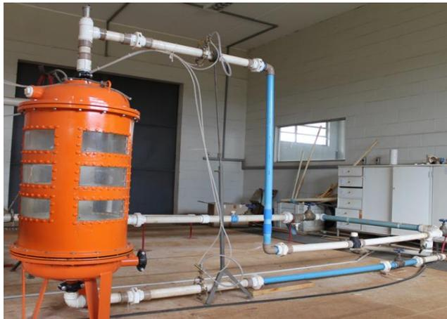
**Figura 11:** Módulo experimental instalado no circuito hidráulico. (Foto: Marcio Mesquita)
