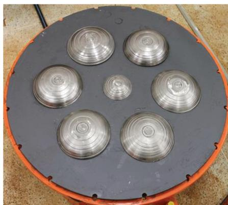
**Figura 45:** Detalhe do fundo falso com drenos rosqueados e instalados de acordo com o arranjo espacial proposto. (Foto: Marcio Mesquita)
