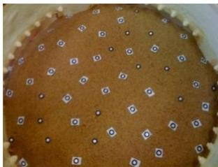
**Figura 21:** Mapeamento esquemático do georreferenciamento da superfície do leito filtrante por tags refletoras. (Foto: Marcio Mesquita)
