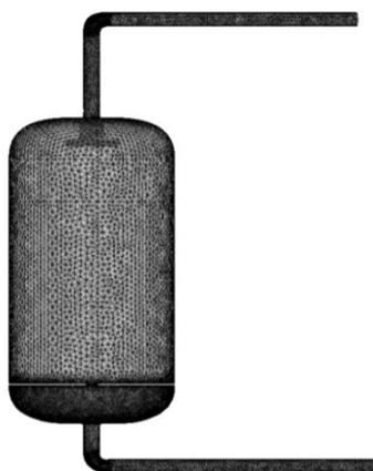
**Figura 14:** Detalhe dos volumes de controle utilizados na geometria estrutural do corpo do filtro ensaiado.
