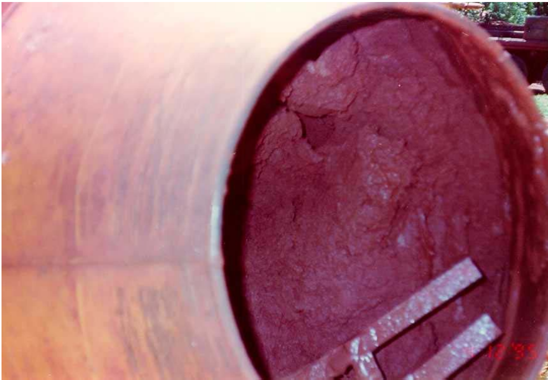
Figura 4.3 – Produção do SCP em betoneira
