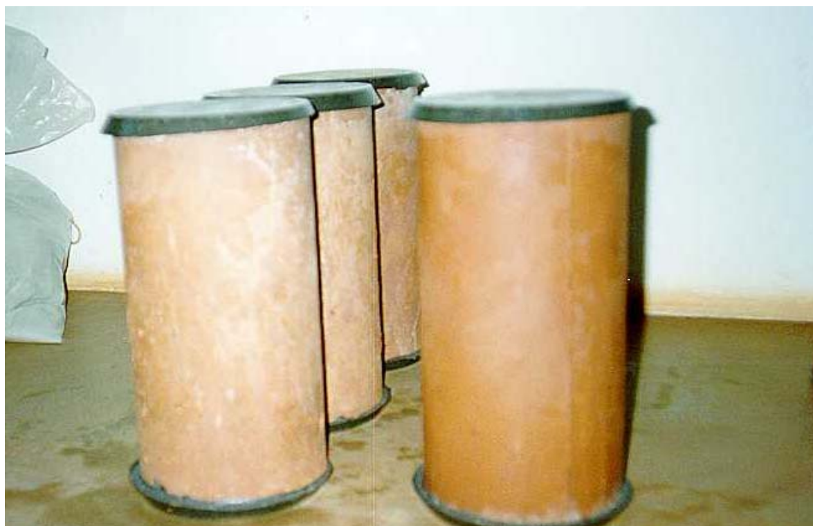
Figura 4.6 – Corpos-de-prova de SCP (15 cm x 30 cm) capeados com enxofre
