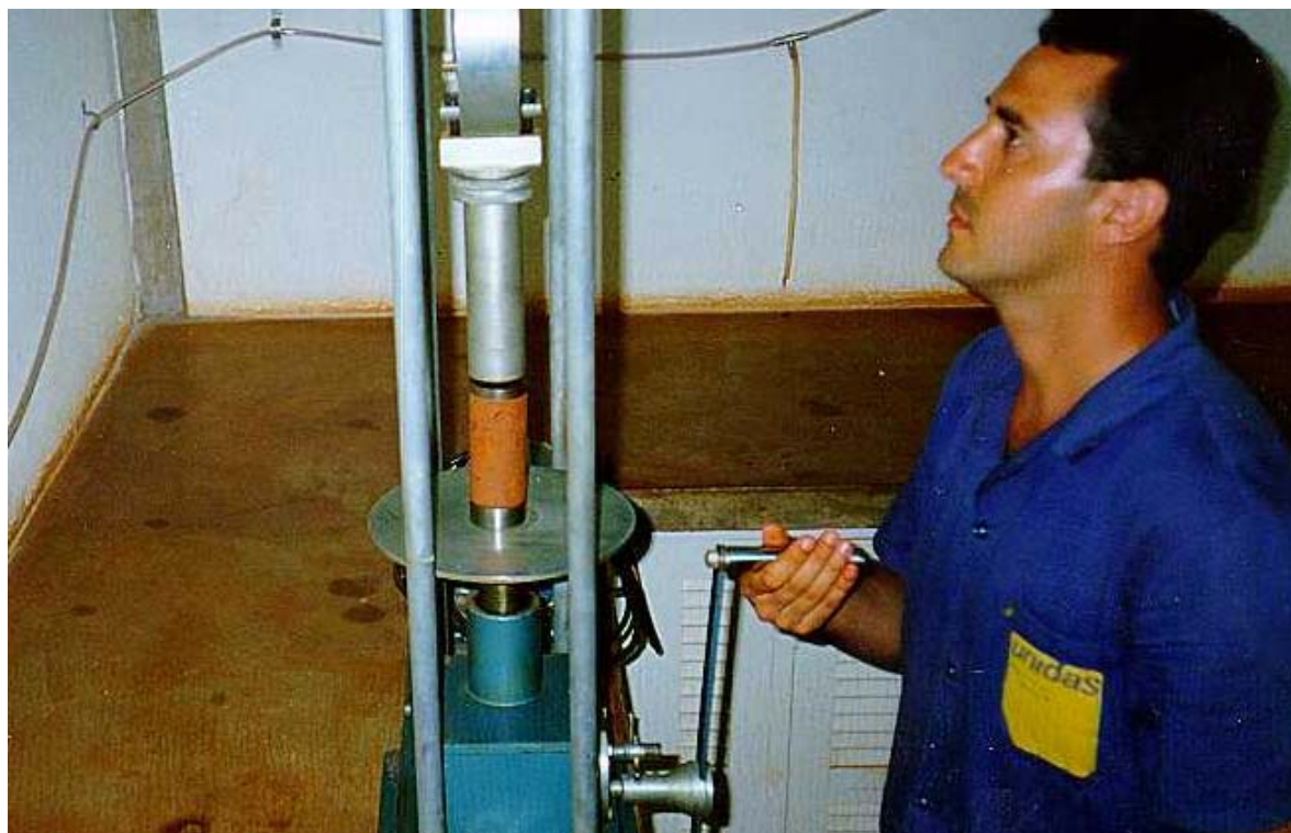
Figura 4.5 – Ruptura dos corpos-de-prova de 5 cm x 10 cm
