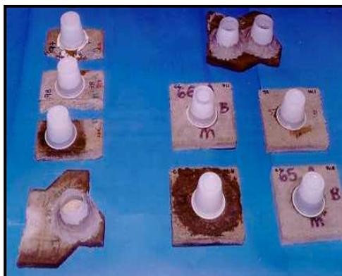
**Figura 14.** Ensaio de resistência ao ataque químico.
