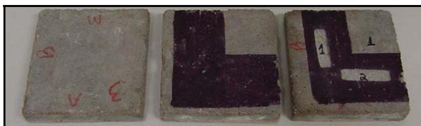
**Figura 37.** Resultado do desgaste das peças por abrasão profunda.
