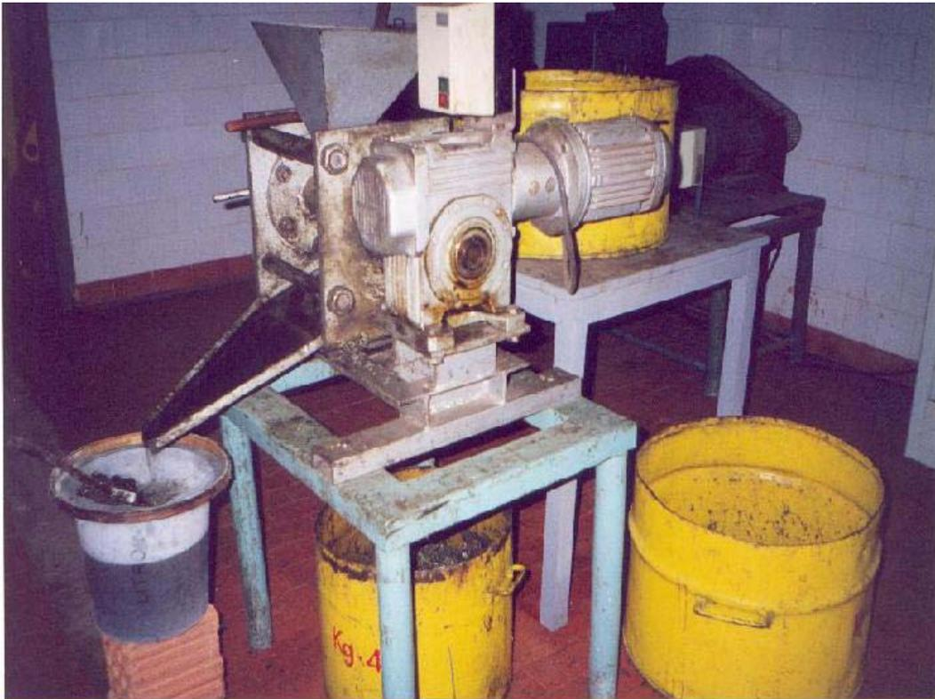
**Figura 4. Prensa usada para extração de óleo**
