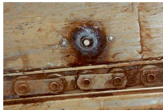
**Figura 18** - Detalhe externo e interno da fixação do sensor de proximidade no elevador da colhedora
