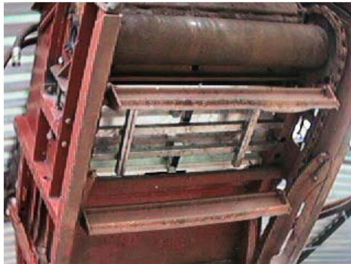
**Figura 12** – Acoplamento do transdutor na esteira de uma colhedora BRASTOFT A-7700
