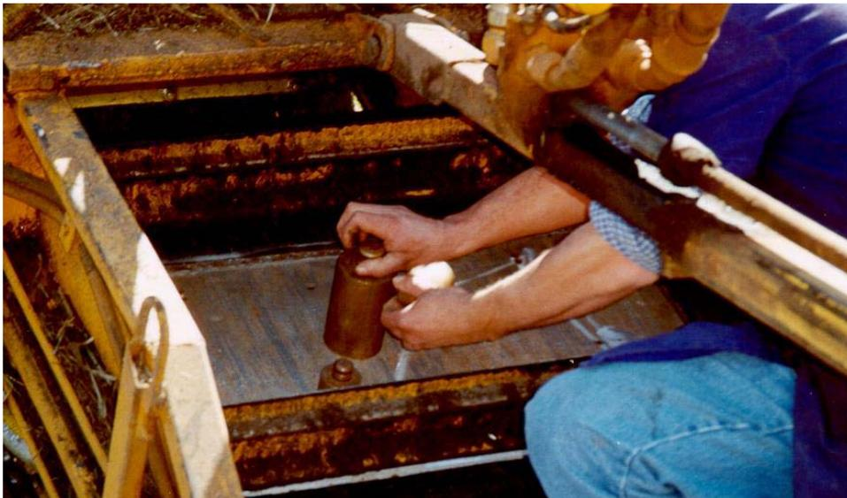
**Figura 13** – Calibração da balança montada na colhedora
