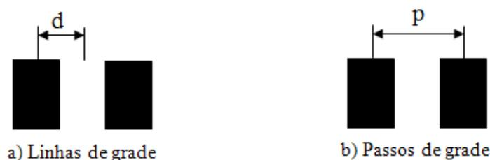
Figura 07. Definição dos termos de grade com relação a: a) Linha de grade e b) Passo de grade. Fonte: (GAZZOLA, 2011).
