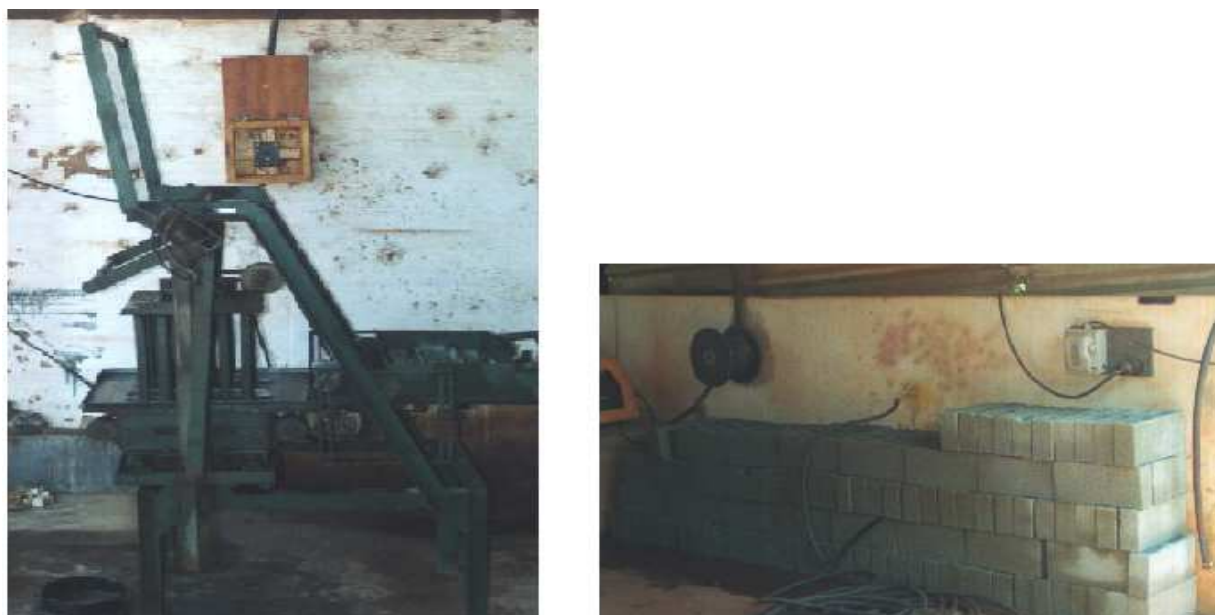
Figura 7. Equipamento de fabricação dos blocos e blocos vazados de argamassa de cimento e casca de arroz.
