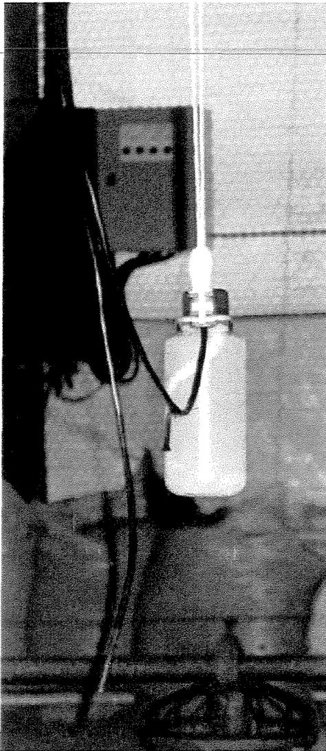
Figura 19. No fundo o controlador Climatic I e os sensores de bulbo seco e bulbo úmido com seu reservatório para água.
