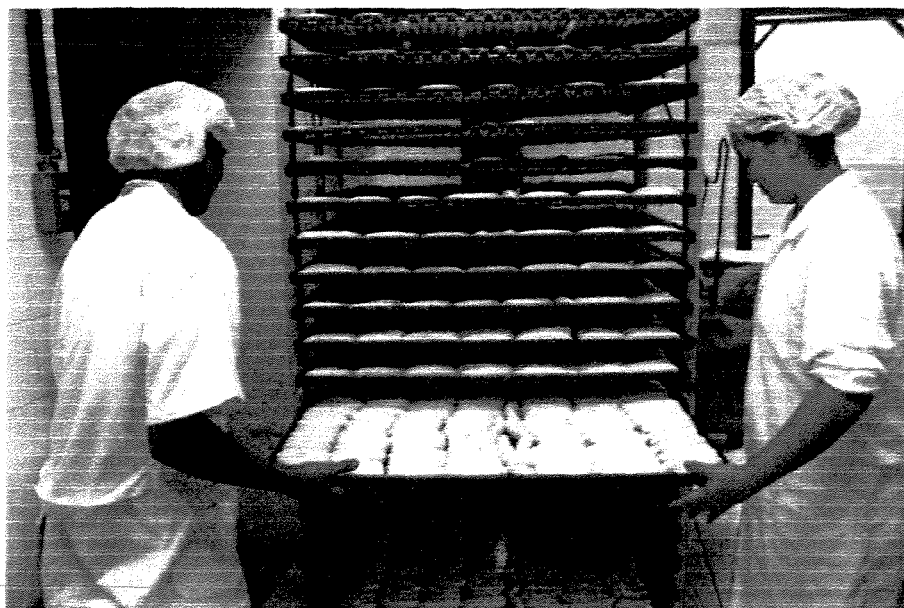
Figura 12 – Carregamento das bandejas no carrinho do secador
