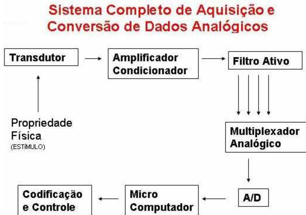
Figura 4.2.5. Sistema Completo de Aquisição/Conversão de dados Analógicos.
