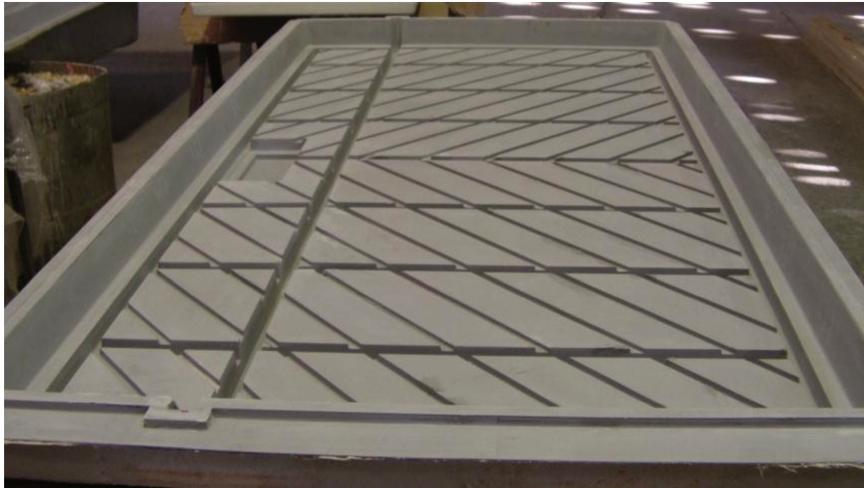
**Figura 9. Ilustração do molde para fabricação da mesa de subirrigação.**
