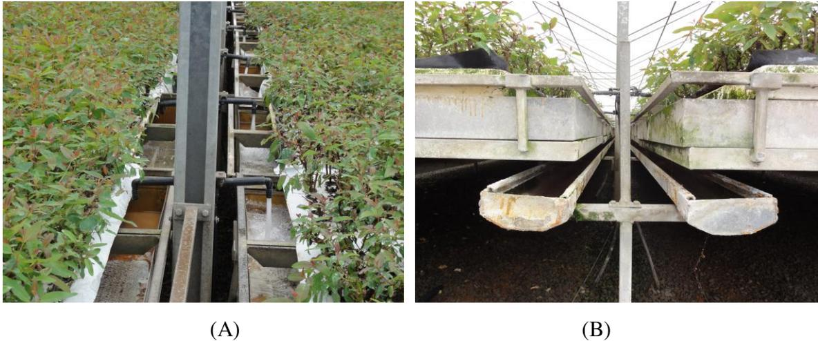
**Figura 5. Ilustração do sistema de adução (A) e de drenagem (B) das mesas de subirrigação.**
