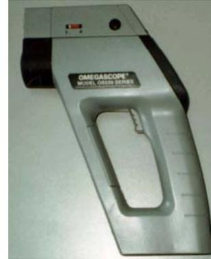
*Figura 11. Temômetro infravermelho*
