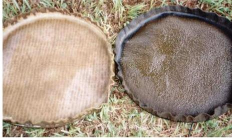
Figura 11: Mantas não tecidas (M1 e M2) após um ensaio com o Filtro Lento
