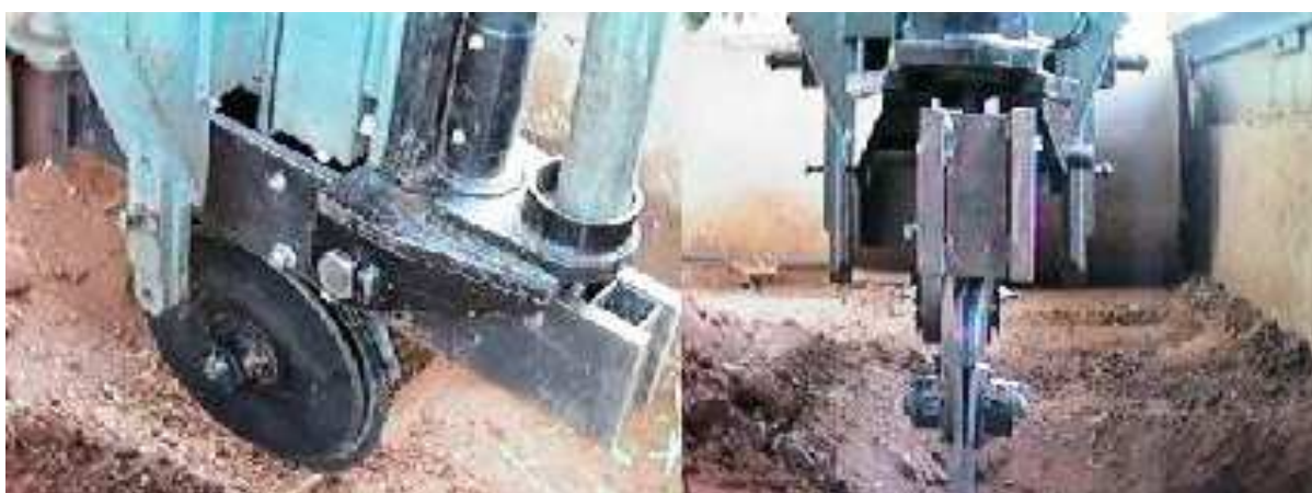
Figura 13. Discos duplos utilizados para o tratamento dd .
