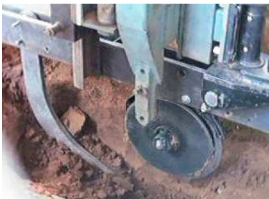
Figura 17. Conjunto discos duplos e haste escarificadora, para o tratamento ddhe .
