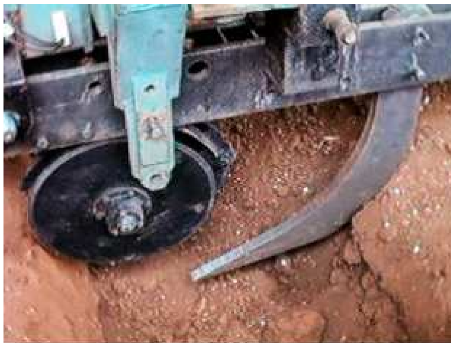
Figura 16. Conjunto discos duplos e haste curta, utilizado no tratamento ddhc .
