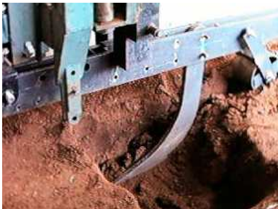
Figura 15. Haste escarificadora, utilizada para o tratamento he .
