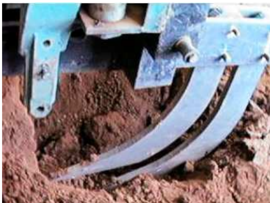
Figura 19. Conjunto haste curta e haste escarificadora, para o tratamento hche .
