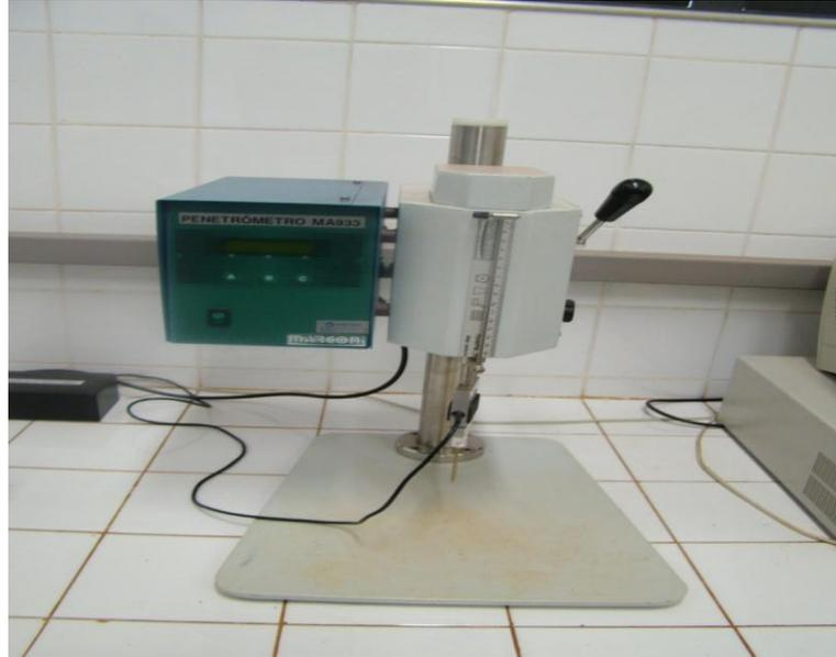
Figura 5. Penetrômetro eletrônico marca Marconi, modelo MA-933.
