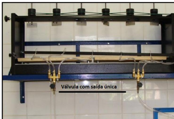
**Figura 12:** Adaptação com válvula de saída única para cada 3 jarros em um filtro.
