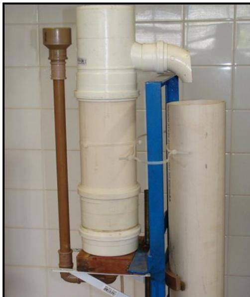
**Figura 16:** Unidade de Pré-Filtração constituído por camadas de pedregulho.
