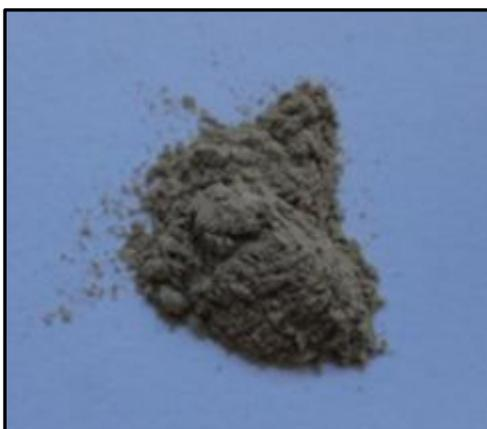
**Figura 3:** Bentonita utilizada no preparo da água para tratamento.
