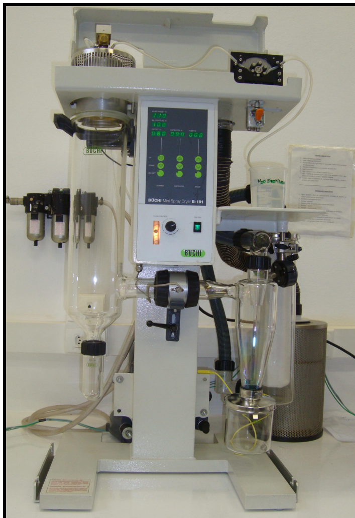
Figura 3.1 - Mini spray dryer utilizado nos ensaios de secagem por aspersão.
