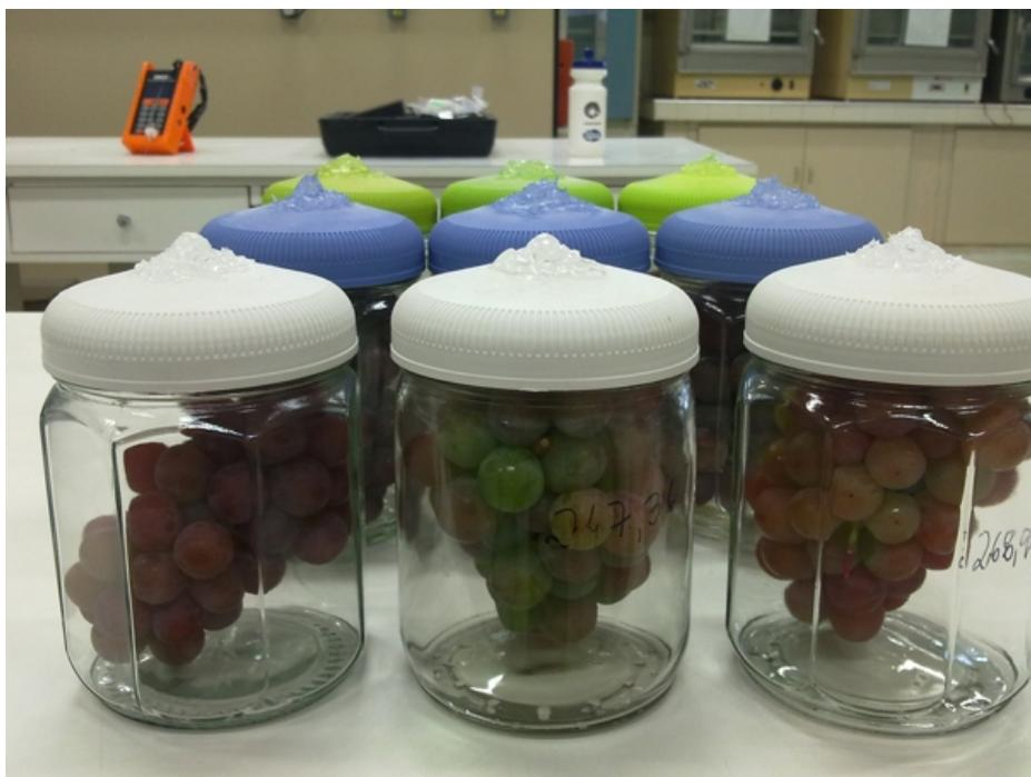
**Figura 14** – Acondicionamento dos cachos de uva em recipiente de vidro durante as medições de O<sup>2</sup> e CO<sup>2</sup>.
