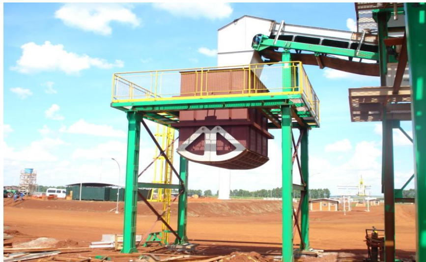
Figura 16: Moega para captura de impurezas minerais retiradas pela grelha da mesa alimentadora – Usina Monteverde.
