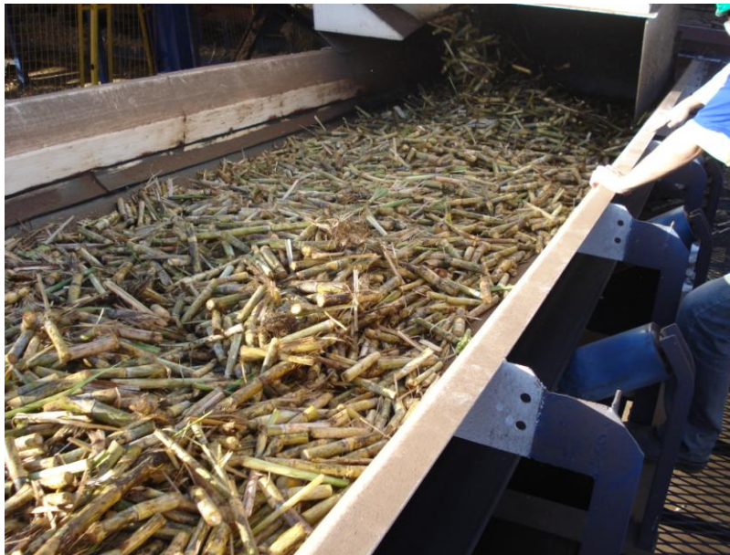
Figura 22: Colmo + impurezas não separadas pelo sistema de limpeza.
