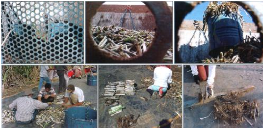
Figura 6: Tambores posicionados dentro do transbordo e separação do material em classes.
