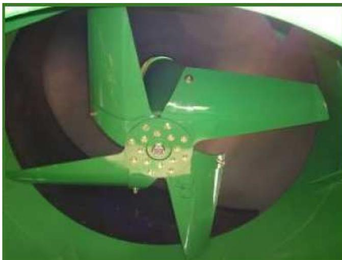
Figura 3- Ventilador do extrator primário da colhedora JD. (Fonte: JOHN DEERE, 2010)
