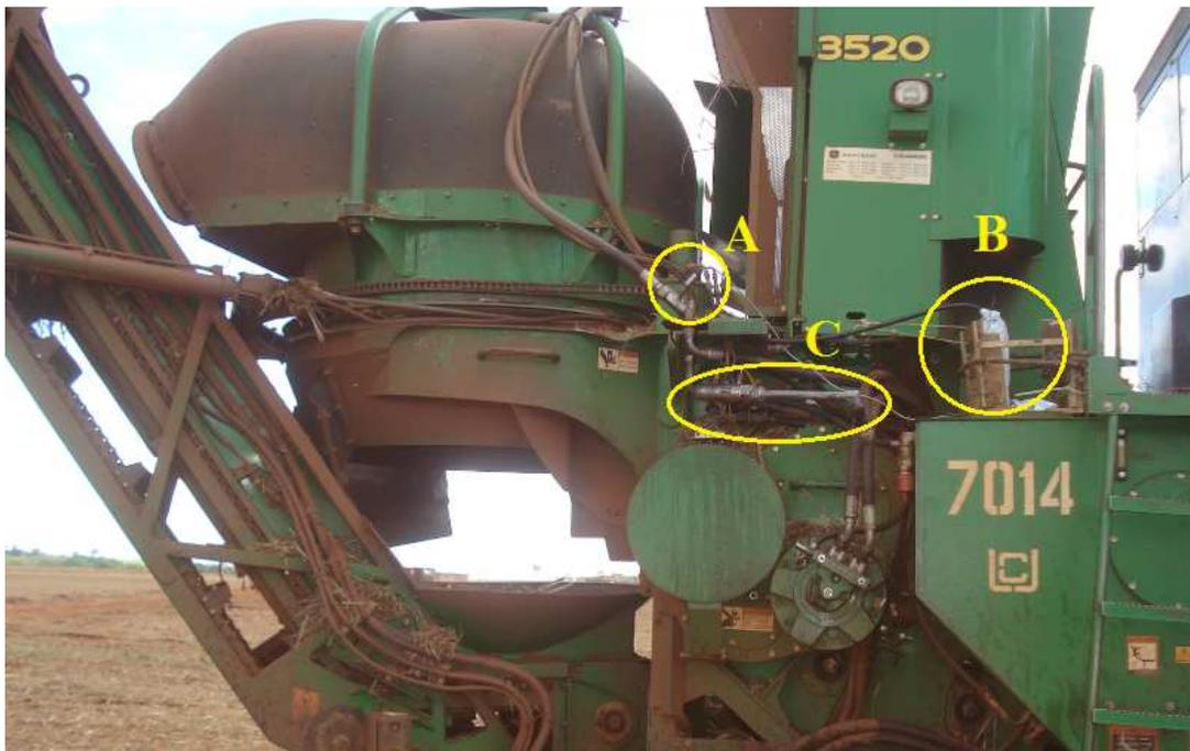
Figura 15- Instrumentação da colhedora utilizada no Ensaio 2. (A) Transmissor de Pressão; (B) Monitor EM 20; (C) Fluxômetro
