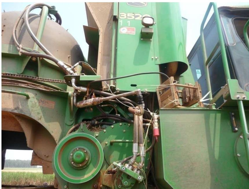
Figura 17- Instrumentação da colhedora de cana utilizada no Ensaio 3
