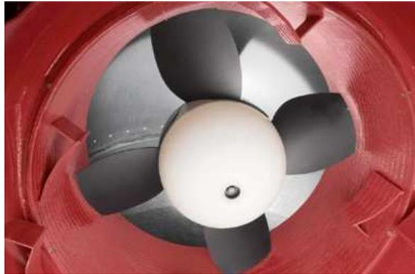
Figura 6- Ventilador do extrator primário da colhedora de cana CASE. (Fonte: CASE IH, 2006).
