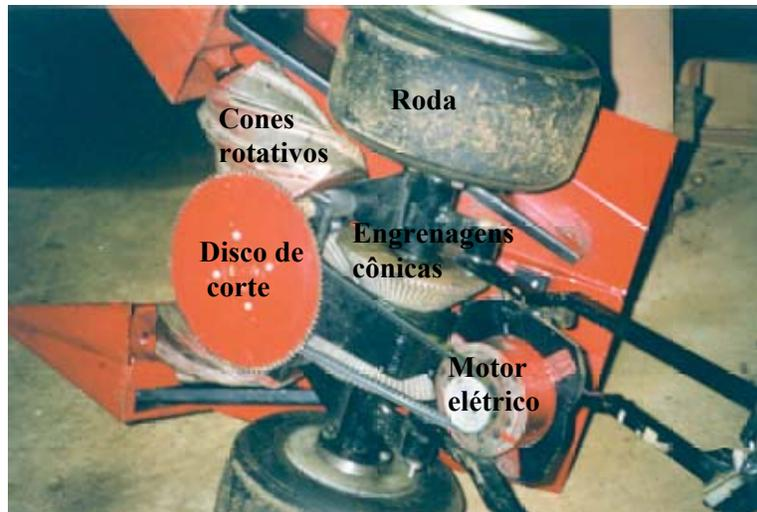
**Figura 9** – Vista inferior do mecanismo utilizado para o corte e elevação dos feijoeiros.
