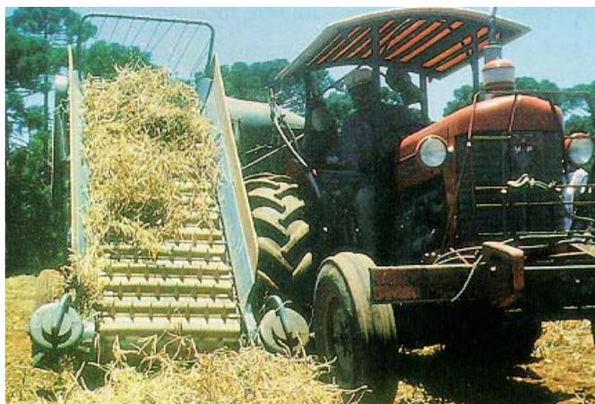
**Figura 1** - Trilhagem de feijão, após arranquio e secagem com recolhedor-batedor com sistema axial
