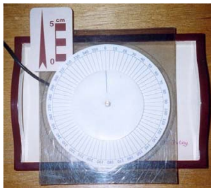
FIGURA 21 - Sistema de calibração do potenciômetro
