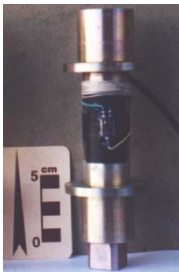
FIGURA 15 - Torquímetro elétrico com capacidade máxima de 50 kgf.m
