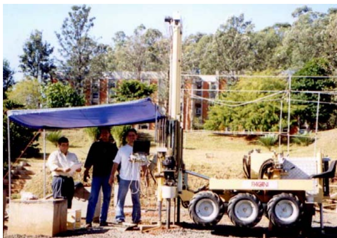
FIGURA 35 - Penetrômetro utilizado para cravação da ponteira nos ensaios de CPT
