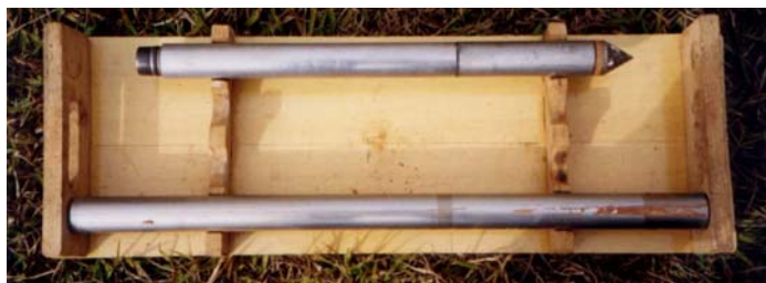
FIGURA 34 - Ponteira Cone-atrito elétrica, utilizada nos ensaios CPT
