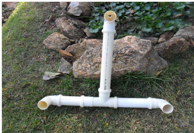
**Figura 06** – Tubos de PVC para aeração das caixas com tilápias.
