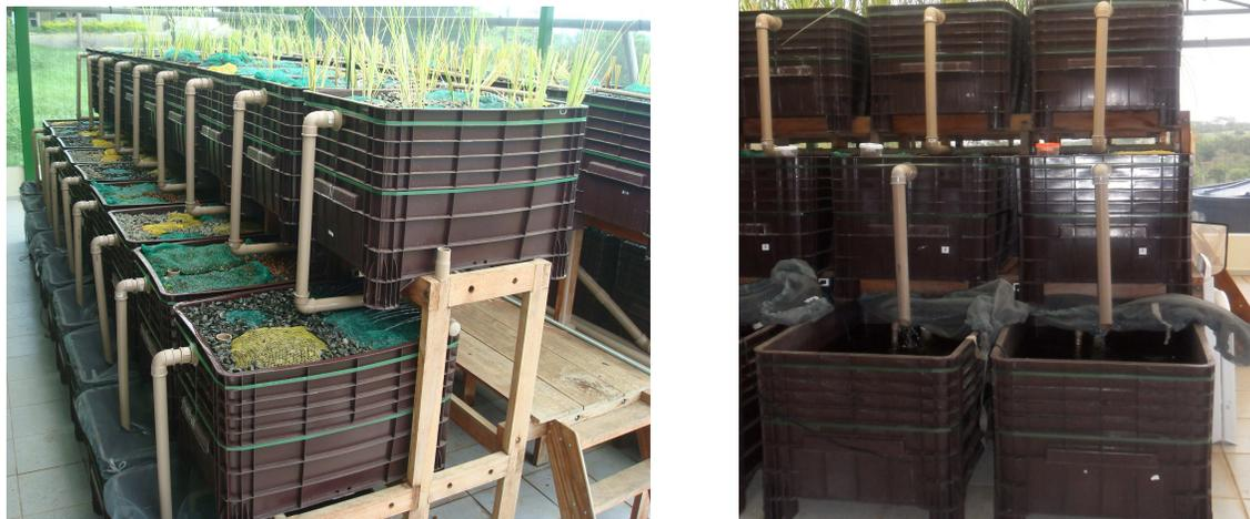
**Figura 01** – Vista lateral e vista frontal do sistema modular de leitos cultivados.
