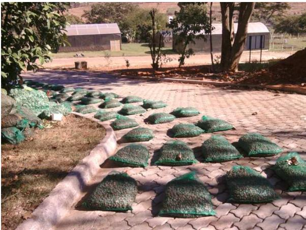
**Figura 04b** – Sacos de argila expandida colocados para secar após a lavagem.
