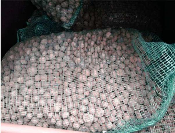
**Figura 04a** - Detalhe da argila expandida ensacada em saco de nylon de 5 kg.
