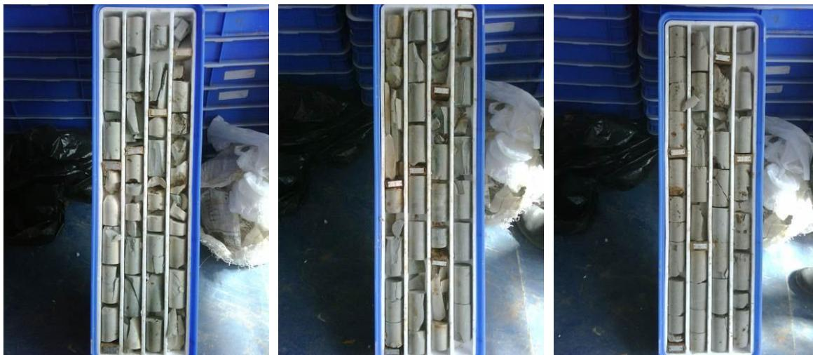
**Figura 4.6** – Caixas de amostras colhidas por meio de sondagens rotativas
