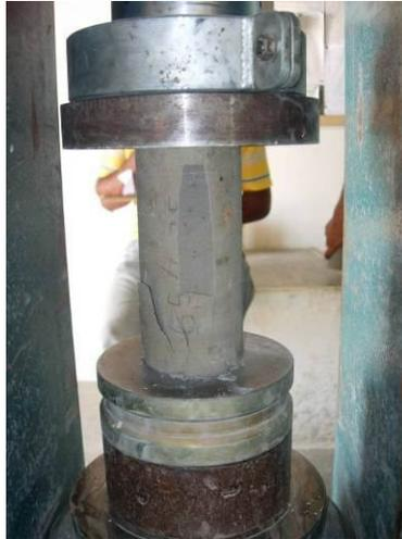
**Figura 4.10.** Execução de ensaio de compressão em corpo de prova moldado em laboratório
