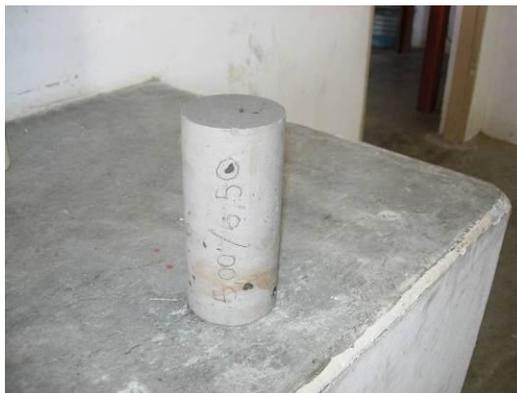
**Figura 4.9.** Corpo de prova cilíndrico moldado em laboratório
