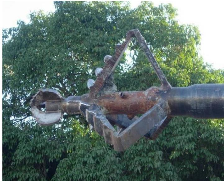
**Figura 2.6.** Detalhe da ferramenta de corte e mistura
