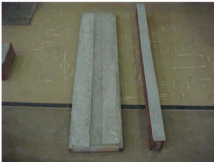
FIGURA 4.05 – Falha no sistema de ligação por epoxi
