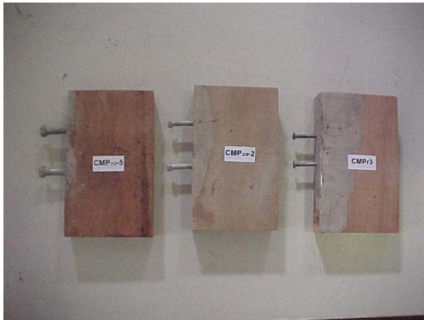
FIGURA 4.12 – Detalhe dos conectores flexíveis
