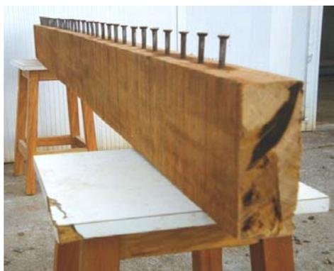
(a) vista de conectores instalados na viga
