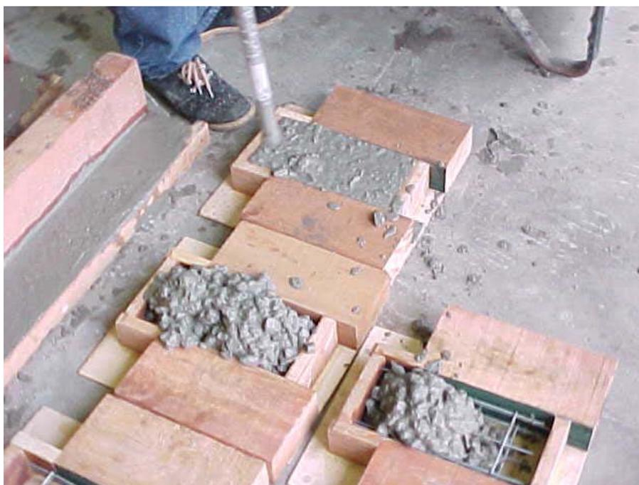
FIGURA 4.08 – Concretagem dos corpos-de-prova das ligações
