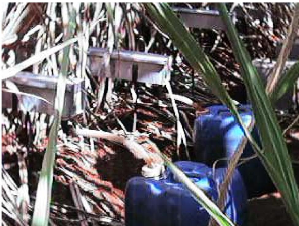
**Figura 5 – Sistema de coleta de precipitação que atravessa a vegetação e atinge o solo**
