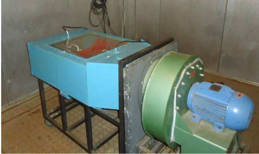
Figura 13. Câmara de secagem com túnel de ar forçado.
