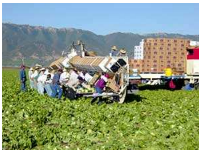
Figura 3. Plataformas móveis de auxílio a colheita de plantas de alface. Fonte. UnimacFeagri.
