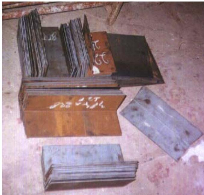
Figura 120a) Detalhe das chapas dobradas para a produção das peças de encaixe.
