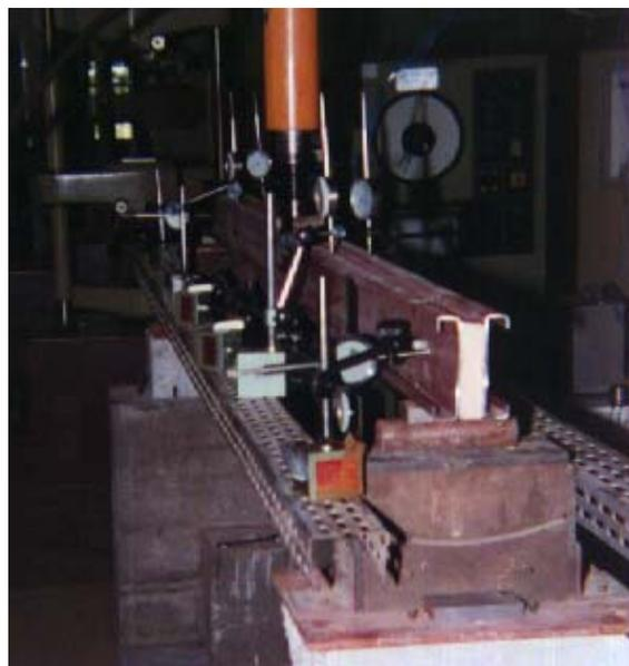
Figura 61 Foto do pórtico de carga aplicada à viga mista com três parafusos no momento do carregamento.
