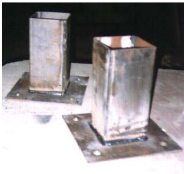
Figura 120b) Detalhe da montagem de uma sapata de encaixe da fundação.
