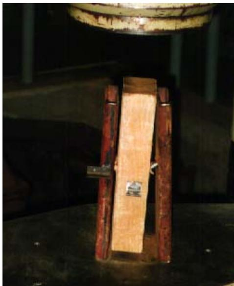
Figura 89 Ruptura da ligação por embutimento e flexão do parafuso
