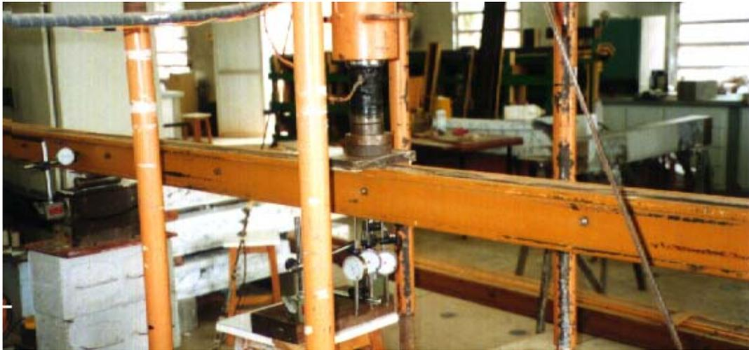
Figura 94 Viga mista sendo ensaiada no pórtico de cargas e os relógios comparadores posicionados.
