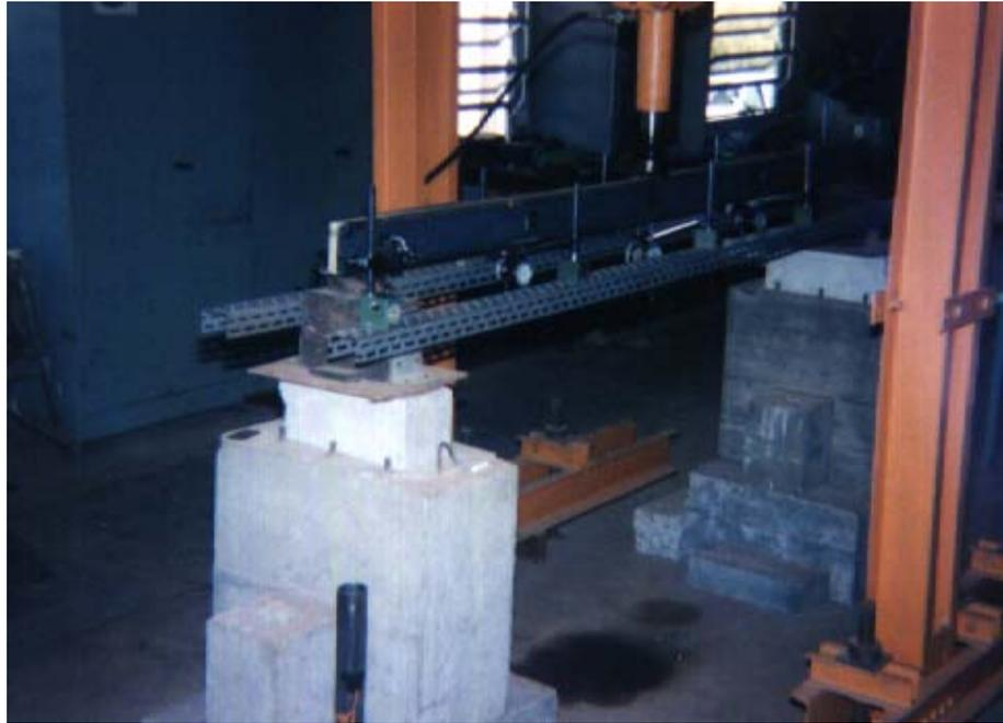
Figura 65 Foto da viga mista com 5 parafusos de diâmetro 12mm alinhados na alma no momento do carregamento.
