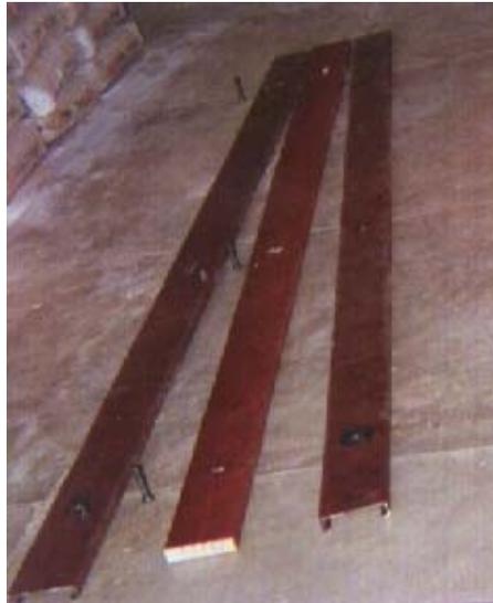
Figura 59 Foto dos elementos da viga e os respectivos parafusos.
