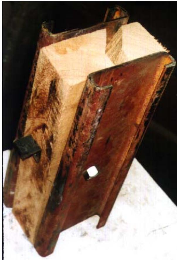
Figura 88 Foto da ruptura do parafuso e fendilhamento da madeira.
