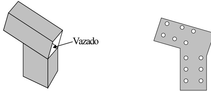
Figura 117 Vistas geral e lateral do encaixe entre viga e pilar.
