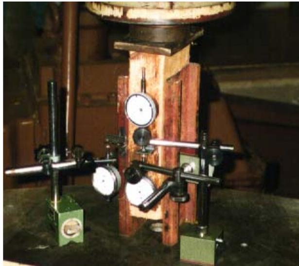
Figura 84 Fotos de um ensaio da ligação contendo chapa metálica e madeira com parafuso
