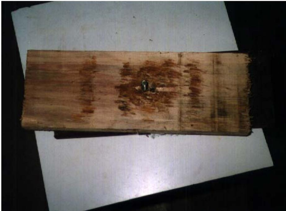
Figura 56 Corpo de prova após o ensaio onde houve o embutimento do parafuso na madeira.
