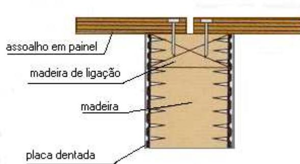
Figura 13 União de peças de madeira através de chapa dentada
