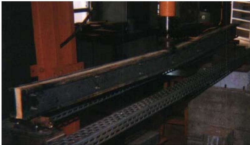
Figura 77 Foto no momento de ruptura de uma viga mista com parafusos de 6mm alinhados próximos à mesa calculados pelo fluxo de cisalhamento.
