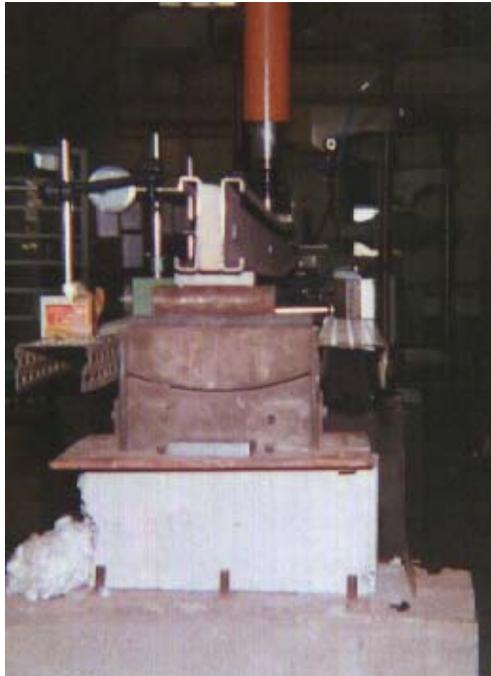
Figura 64 Foto da ruptura do modelo com 3 parafusos de 12mm de diâmetro.
