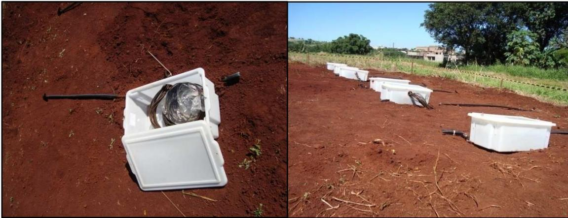
Figura 10. Caixas plásticas para proteção dos cabos coaxiais e dos conectores BNC
