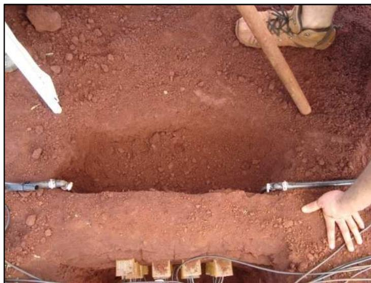
Figura 15. Instalação do gotejador na parede da trincheira
