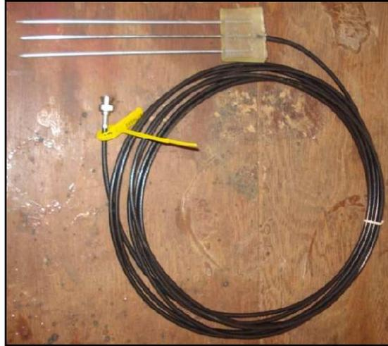
Figura 7. Sonda de TDR utilizada no experimento
