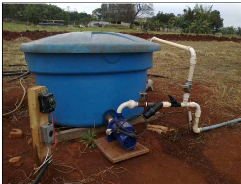
Figura 13. Conjunto moto-bomba, regulador de pressão, filtro, registros e “bypass” utilizados no experimento para realizar a irrigação.
