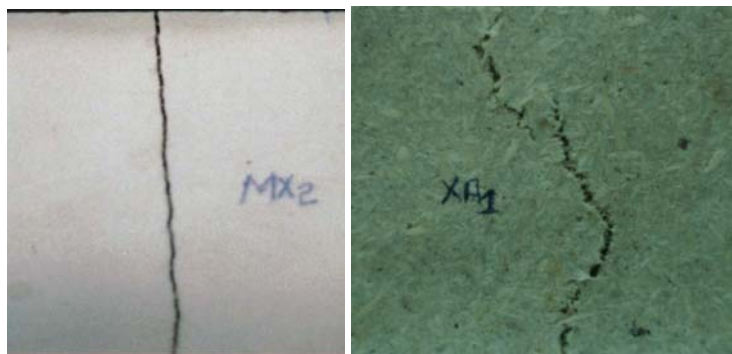
Figura 4.20: Fissura em aglomerados com e sem revestimento, ensaiados à flexão
