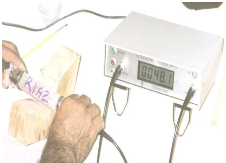
Figura 3.12: Medição da velocidade de propagação do som, utilizando o equipamento de ultrassom.
