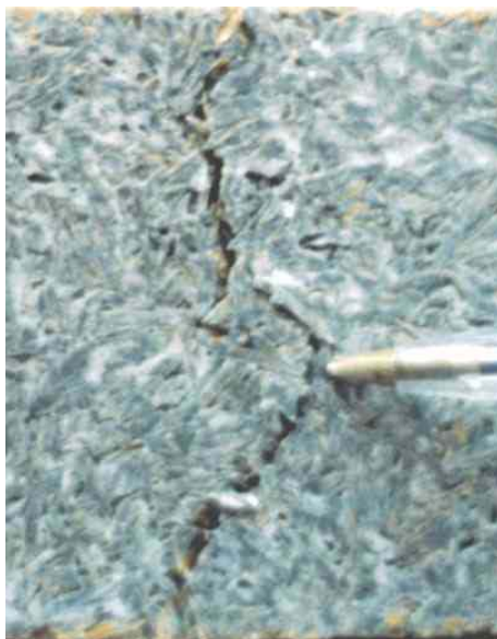
Figura 4.18: Fissura em compósito à base de casca de arroz, ensaiado à flexão
