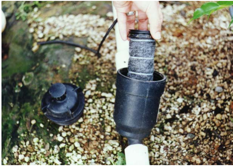
Figura 2: Estrutura de fixação da manta sintética não tecida
